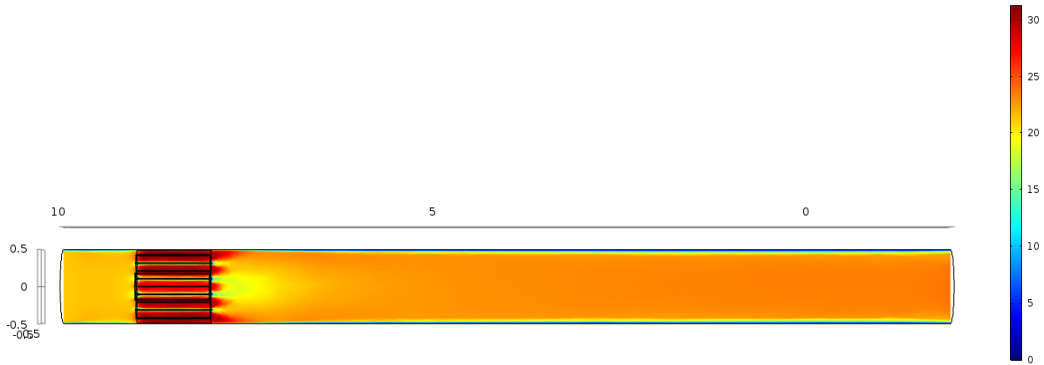
a) Εσωτερική Διάμετρος 1cm , Μήκος 12cm, Ταχύτητα ροής εισόδου 21,22 m/s
