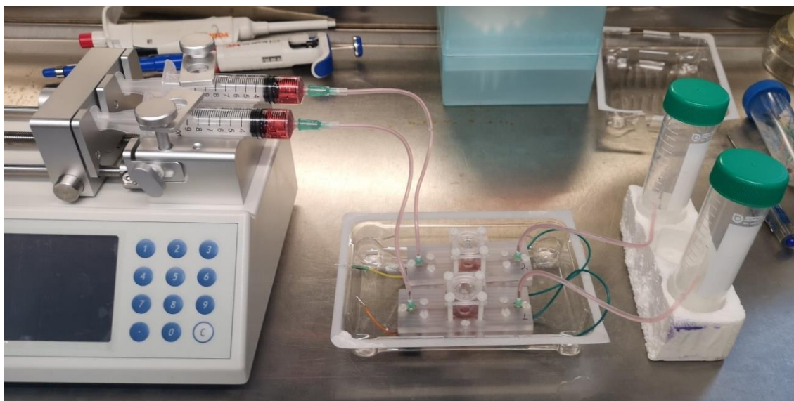
Σχ.50. Η μικρορευστομηχανική διάταξη συνδεδεμένη με την αντλία σύριγγας και την εξαγωγή. Στο πηγάδι περιέχει και την καλλιέργεια κυττάρων. Το ροζ υγρό είναι θρεπτικό διάλυμα κυττάρων.
