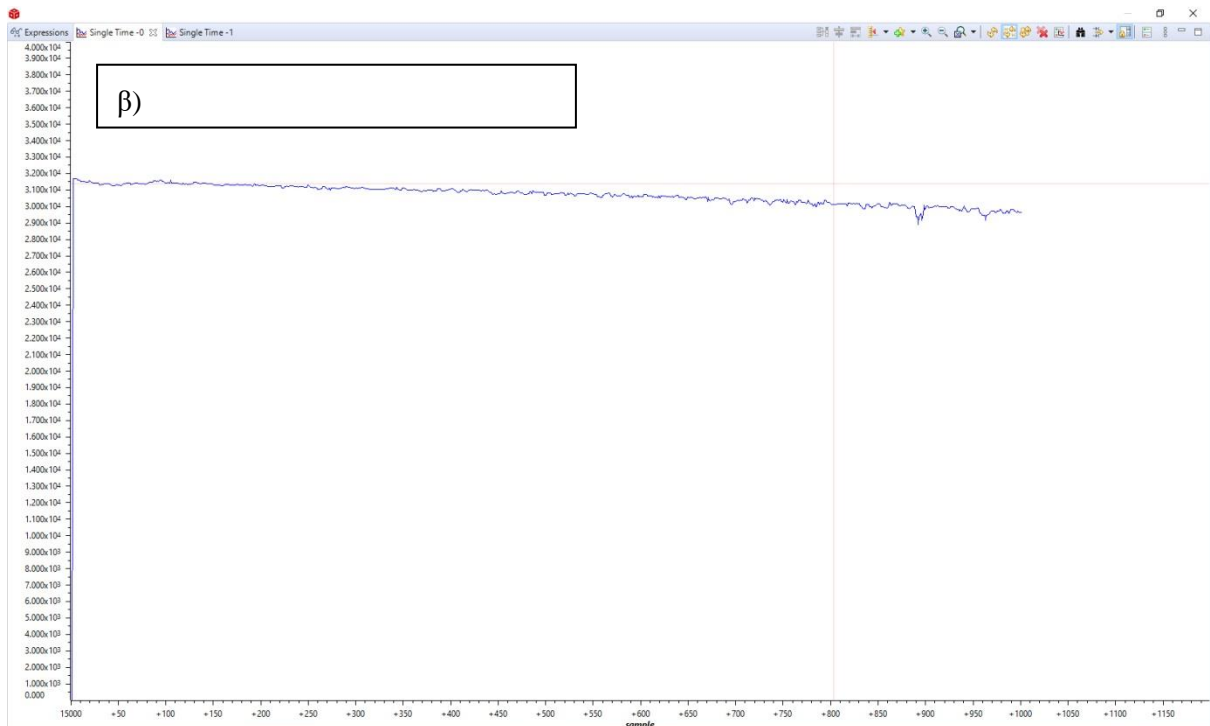
Σχ.81. Γραφική παράσταση από τον CCS debugger όπου απεικονίζεται η απόκριση μέτρου για αντίσταση 33kΩ(χωρίς βαθμονόμηση). Στη δειγματοληψία από το σχήμα α) δεν έχει εφαρμοστεί φίλτρο κυλιόμενης διαμέσου, ενώ στο β) έχει εφαρμοστεί φίλτρο κυλιόμενης διαμέσου με το ελάχιστο δυνατό μέγεθος παραθύρου, n=3 . (Φάσμα 10Hz-10kHz. Η 1000στή μέτρηση, στη δεξιά πλευρά, είναι τα 10kHz.)
