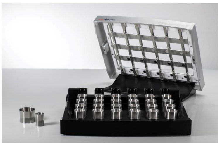
Σχ.28. Multiwell διάταξη μέτρησης σε καλλιέργειες για το όργανο CellZscope. (NanoAnalytics - Münster, Germany)
