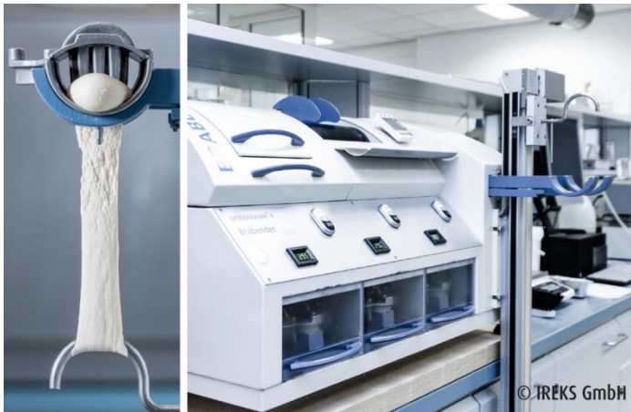
Εικόνα 37 Εξτενσιογράφος και τέντωμα ζυμαριού στον εξτενσιογράφο ( https://www.ireks-kompendum.com/en/ )
