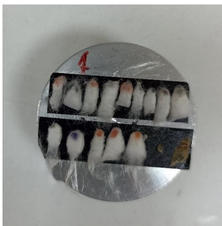
Εικόνα 4.3.1.3: δείγματα εκτυπωτικών μελανιών κατά την προετοιμασία για το SEM.
