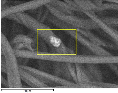
Εικόνα 5.3.5 : απεικόνιση SEM, δείγμα από την σελ. 62, από μαύρο γράμμα, σε μεγέθυνση x900
