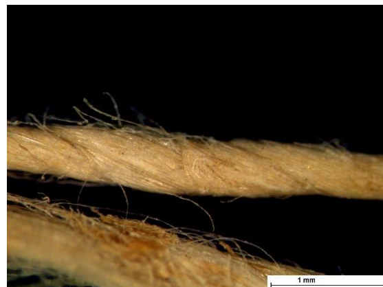
Εικόνα 5.2.8: δείγμα ίνας της ραφής, σε μεγέθυνση x2
