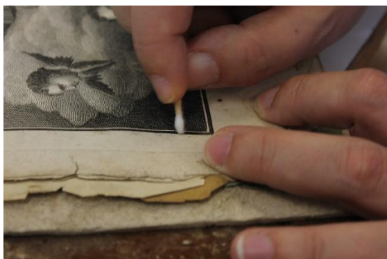
Εικόνα 4.3.1.6: Δειγματοληψία με βαμβακοφόρο στέλεχος
