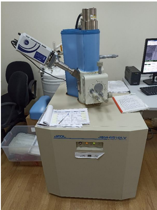
Εικόνα 4.3.4: Το μηχάνημα JEOL JSM-6510LV με το φασματόμετρο ακτίνων-X EDS της Oxford X-act
