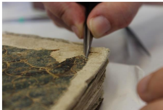
Εικόνα 4.3.1.5: Δειγματοληψία μικροδειγμάτων με τομπίδα ακριβείας
