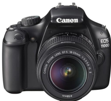
Εικόνα 4.3: Κάμερα Μακροσκοπικής Απεικόνισης Canon EOS 1100D με το φακό EFS 18-55mm f/3.5 - 5.6 IS II.
