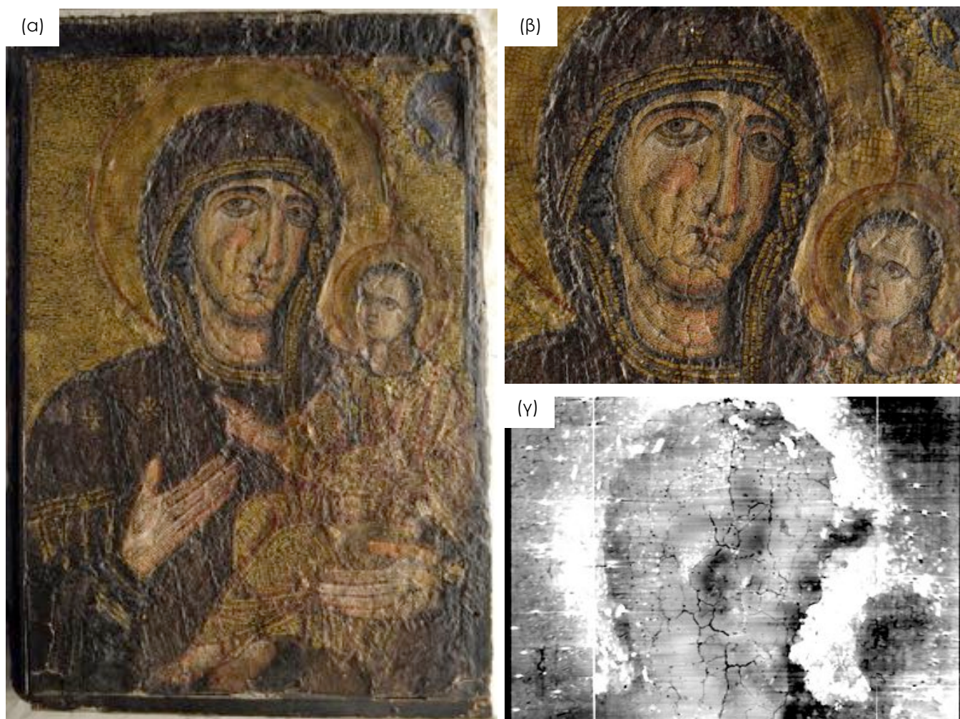
Εικ. 18: (α) Στιγμιότυπο από το πρόγραμμα RTI με πλάγιο φωτισμό από τη δεξιά πλευρά (Πηγή: Βλαχοπούλου, 2017) (β) Λεπτομέρεια εικόνας με πλάγιο φωτισμό (RTI) (Πηγή: Βλαχοπούλου, 2017) (γ) Λεπτομέρεια κρακελαρίσματος του κεριού του στρώματος ψηφοθέτησης στην περιοχή του προσώπου της Παναγίας (CT-Scan) (Πηγή: Chlouveraki, unpublished material)
