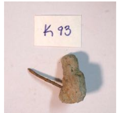
Εικ. 94: Καρφί με κωδικό K93 που κατά την αφαίρεσή του, αφαιρέθηκε και το κονίαμα συμπλήρωσης
