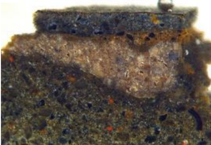
Εικ. 42: Δείγμα P_21_5 της κατηγορίας K3 (α) φωτογραφία από οπτικό μικροσκόπιο (β) φωτογραφία από το SEM με μετρήσεις των κόκκων
