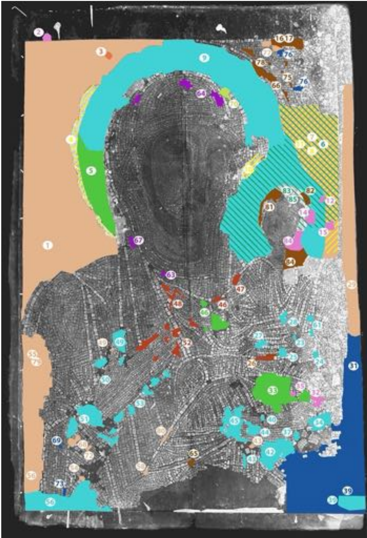
Εικ. 35: Φορητή ψηφιδωτή εικόνα Παναγιάς Παμμακαρίστου. Χαρτογράφηση των κονιαμάτων βάση των αναλύσεων SEM-EDS. Αναγράφεται ο κωδικός του κάθε δείγματος
