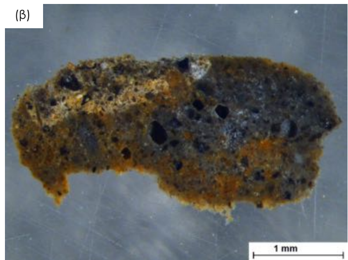
Εικ. 90: Δείγμα P_21_16 (α) πριν και (β) μετά την επιπλέον λείανση του δείγματος
