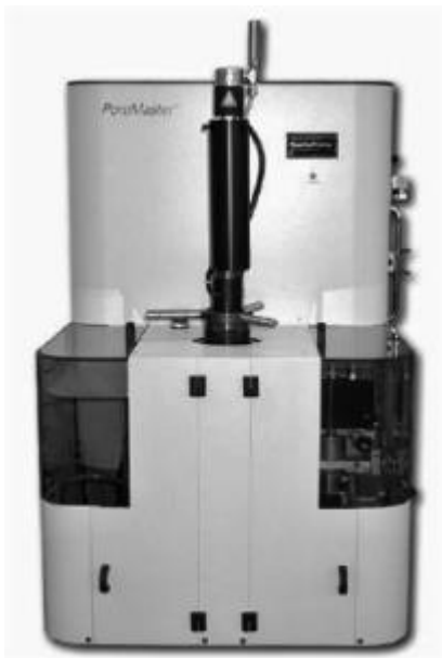
Εικόνα 19. Ποροσίμετρο (Φωτογραφία από σημειώσεις μαθήματος Επιστήμης Ανόργανων Υλικών, Φακορέλλης)
