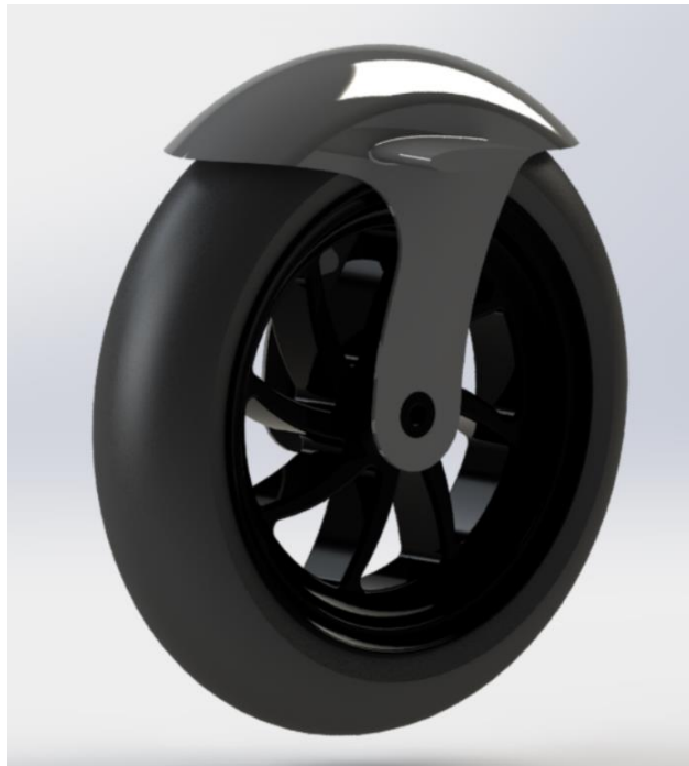
Εικόνα 72: Φωτορεαλιστική Εικόνα συστήματος “Τροχός και φτερό με αεροτομή NACA 23015 (3D όψη)
