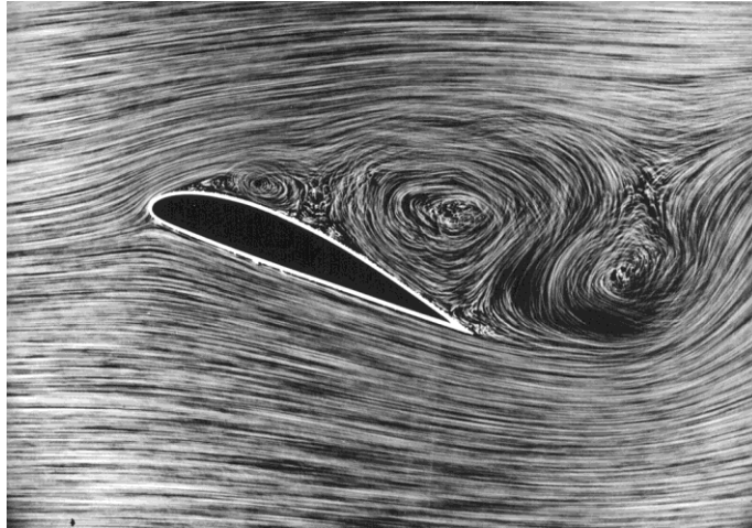
Εικόνα 7: Αποκόλληση ροής σε μεγάλη γωνία προσβολής
