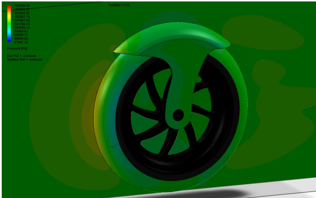
Εικόνα 103: Πεδίο πίεσης γύρω από το φτερό χωρίς αεροτομή.
