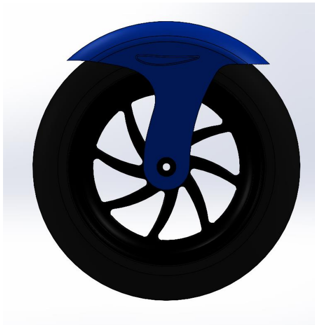
Εικόνα 58: Συστήμα “Τροχός και φτερό με αεροτομή NACA 6412 (πρόοψη)
