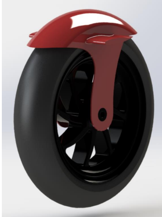
Εικόνα 84: Φωτορεαλιστική Εικόνα συστήματος “Τροχός και φτερό με αεροτομή NASA SC(2)-0714 (3D όψη)
