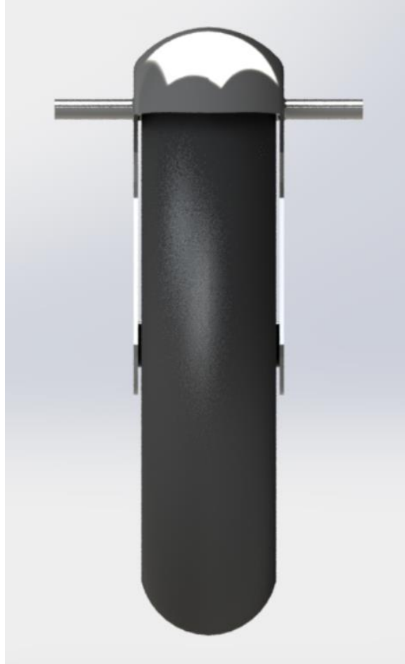
Εικόνα 73: Φωτορεαλιστική Εικόνα συστήματος "Τροχός και φτερό με αεροτομή NACA 23015 (Αριστερή Πλάγια Όψη)
