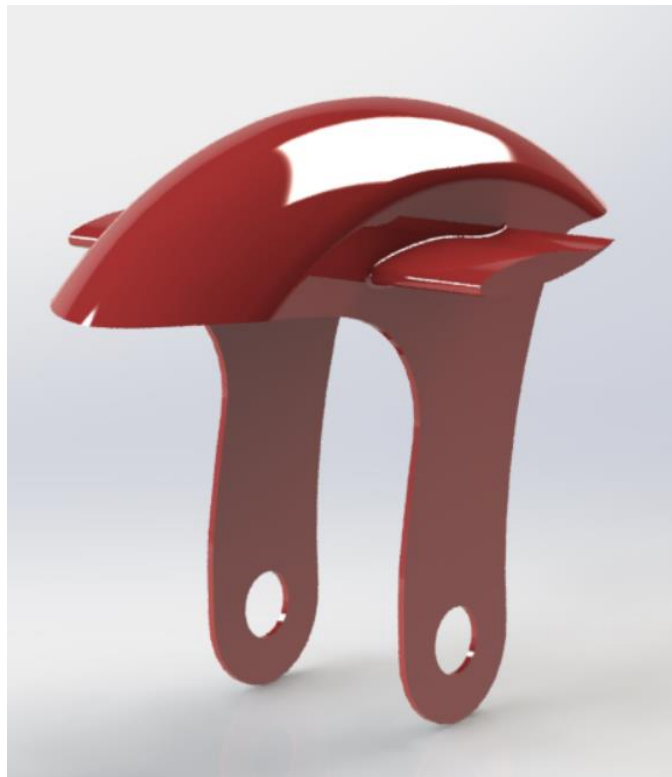
Εικόνα 79: Φτερό με αεροτομή NASA SC(2)-0714 (Αριστερή Πλάγια Όψη)
