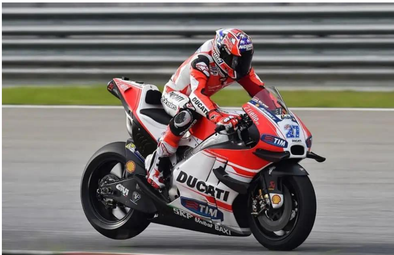
Εικόνα 20: Αεροτομές με τη μορφή πτερυγίων κατά την περίοδο 2016 στο Moto GP
