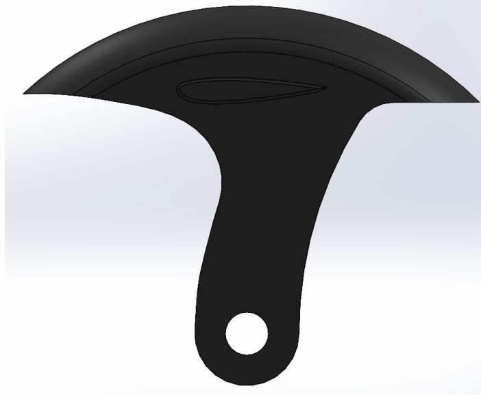
Εικόνα 66: Φτερό με αεροτομή NACA 23015 (Πρόοψη)
