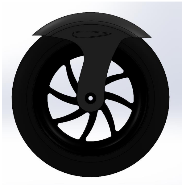
Εικόνα 70: Σύστημα “Τροχός και φτερό με αεροτομή NACA 23015 (πρόοψη)
