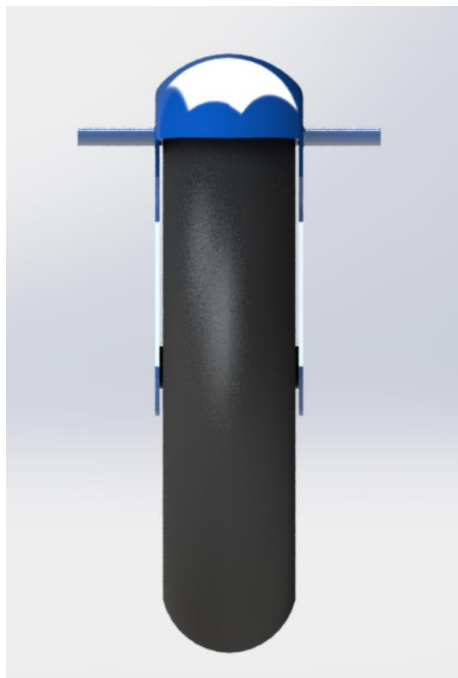
Εικόνα 61: Φωτορεαλιστική Εικόνα υπερσυστήματος “Τροχός και φτερό με αεροτομή NACA 6412 (Αριστερή Πλάγια Όψη)
