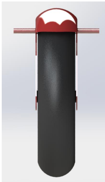
Εικόνα 84: Φωτορεαλιστική Εικόνα συστήματος “Τροχός και φτερό με αεροτομή NASA SC(2)-0714 (3D όψη)
