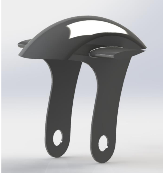
Εικόνα 68: Φωτορεαλιστική Εικόνα αεροτομή NACA 23015 (3D όψη)
