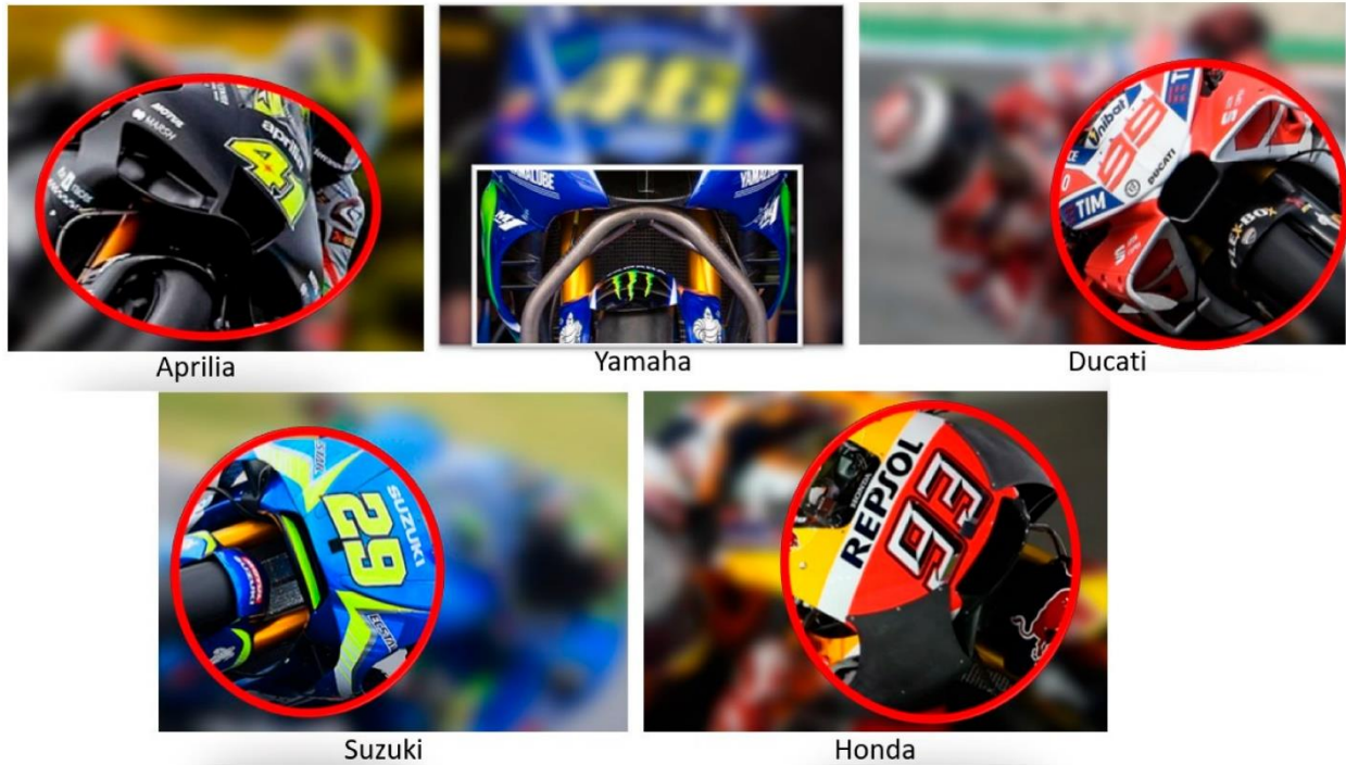
Εικόνα 19: Διαφορετικές αεροδυναμικές επιφάνειες κατά την περίοδο 2017 στο Moto GP (16)
