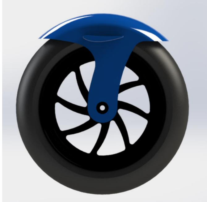
Εικόνα 59: Φωτορεαλιστική Εικόνα συστήματος “Τροχός και φτερό με αεροτομή NACA 6412 (πρόοψη)
