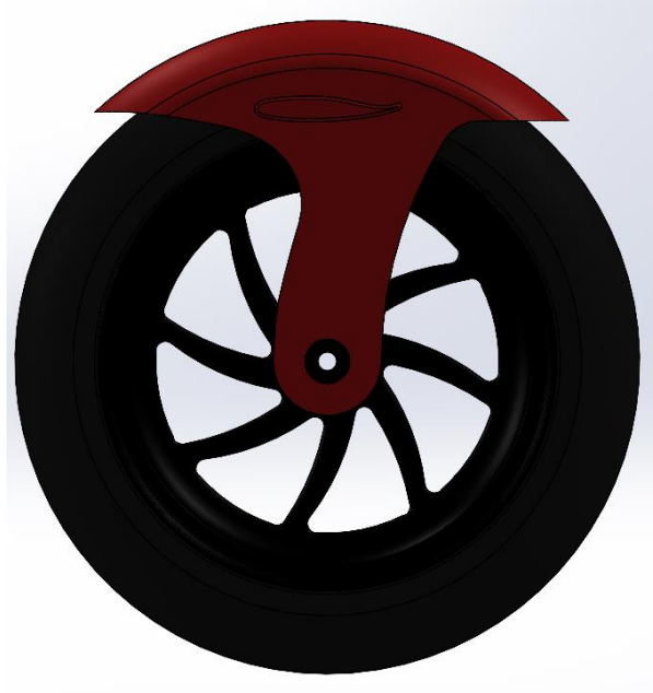
Εικόνα 82: Συστήμα "Τροχός και φτερό με αεροτομή NASA SC(2)-0714 (πρόοψη)
