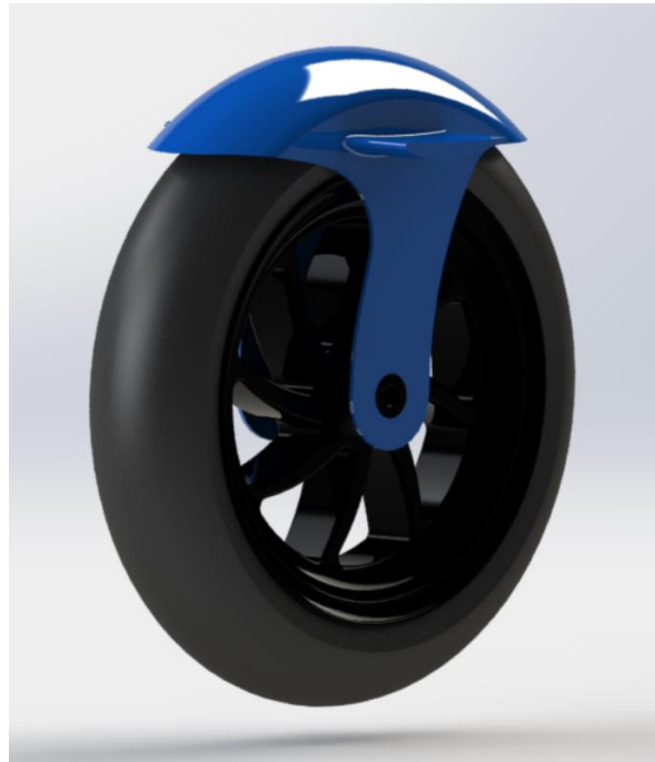
Εικόνα 59: Φωτορεαλιστική Εικόνα συστήματος “Τροχός και φτερό με αεροτομή NACA 6412 (πρόοψη)
