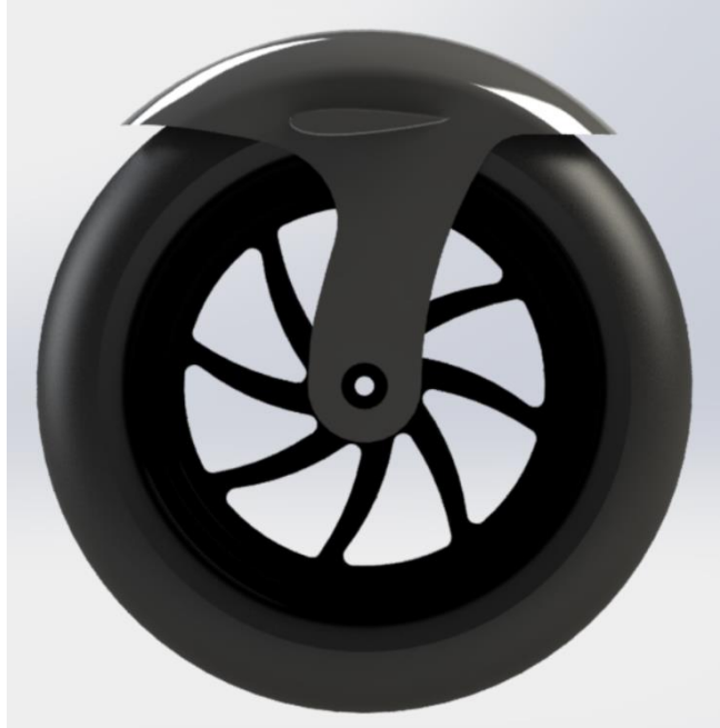
Εικόνα 71: Φωτορεαλιστική Εικόνα συστήματος “Τροχός και φτερό με αεροτομή NACA 23015 (πρόοψη)
