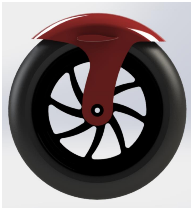
Εικόνα 83: Φωτορεαλιστική Εικόνα συστήματος "Τροχός και φτερό με αεροτομή NASA SC(2)-0714 (πρόοψη)
