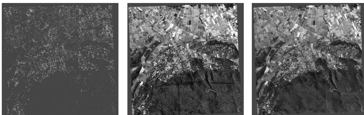
(a) (b) (c) Σχήμα 5.50: TPs (a), Point Cloud (b) και 3D μοντέλο - WorldView-1
