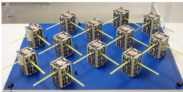
Σχήμα 1.5: Δορυφόροι CubeSat (a) και τα μεγέθη τους (b) [5]
