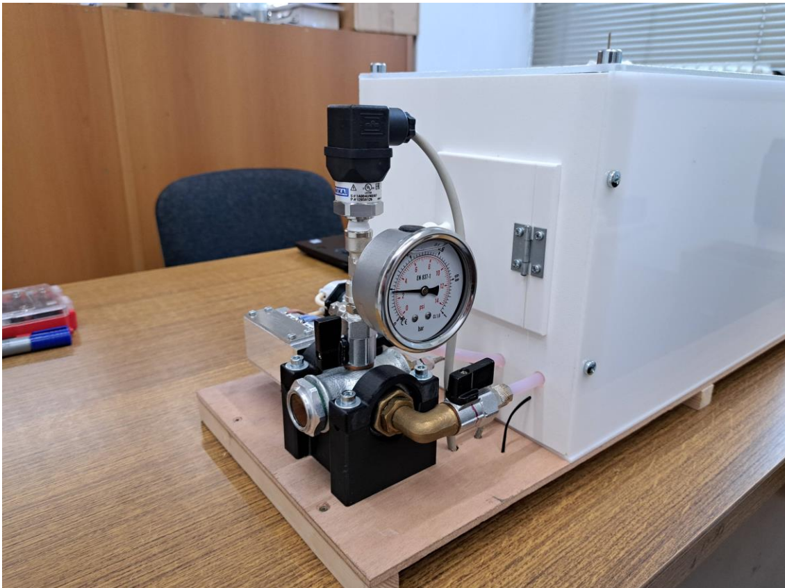
Εικόνα 72: Μπροστινή όψη υδραυλικού κυκλώματος θέρμανσης υγρού
