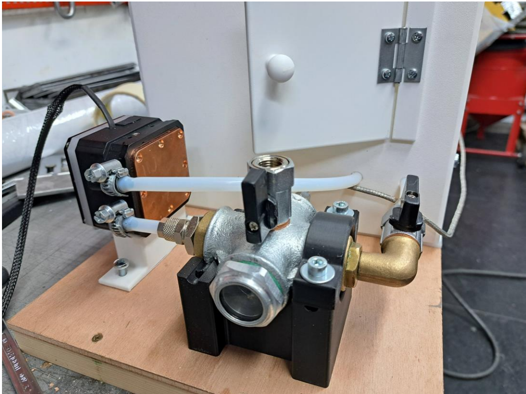
Εικόνα 53: Ενδιάμεσο στάδιο συναρμολόγησης - κύκλωμα υγρού
