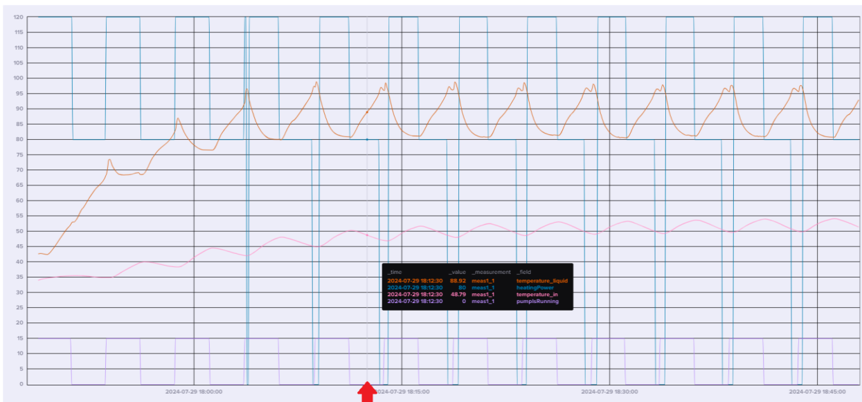
Εικόνα 83: Θερμοκρασία υγρού, Θερμική ισχύς και Θερμοκρασία δωματίου με κλειστή αντλία
