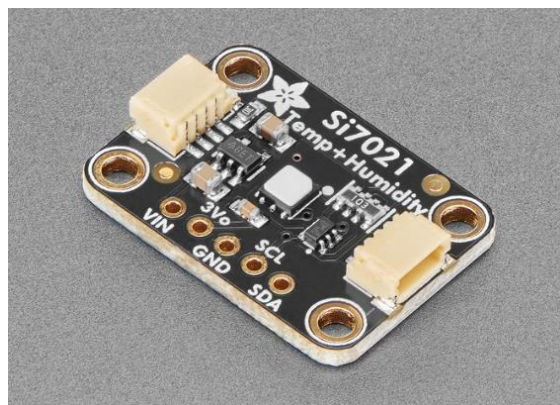
Εικόνα 26: I2C Αισθητήρας “Si7021” για μέτρηση θερμοκρασίας και υγρασίας[51]
