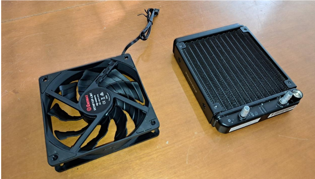
Εικόνα 44: Ανεμιστήρας και εναλλάκτης αποκερματισμένης υδρόψυξης
