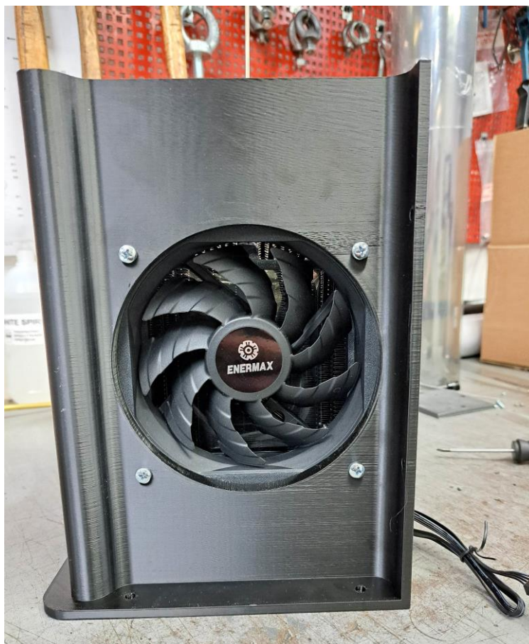
Εικόνα 48: Συναρμολογημένη βάση μπλοκ θέρμανσης – όψη ανεμιστήρα
