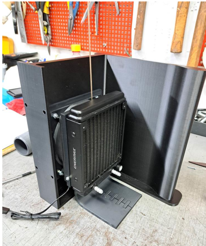
Εικόνα 47: Συναρμολογημένη βάση μπλοκ θέρμανσης – όψη εναλλάκτη
