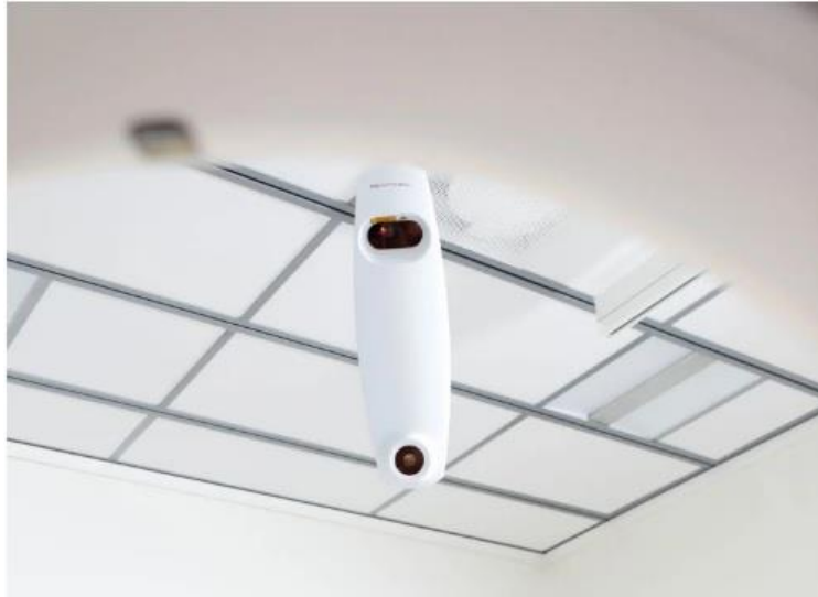
Εικόνα 4. Sentinel 4DCT το σύστημα οπτικής σάρωσης επιφάνειας βασισμένο σε λέιζερ με λειτουργικότητα για ανακατασκευή 4DCT [66].
