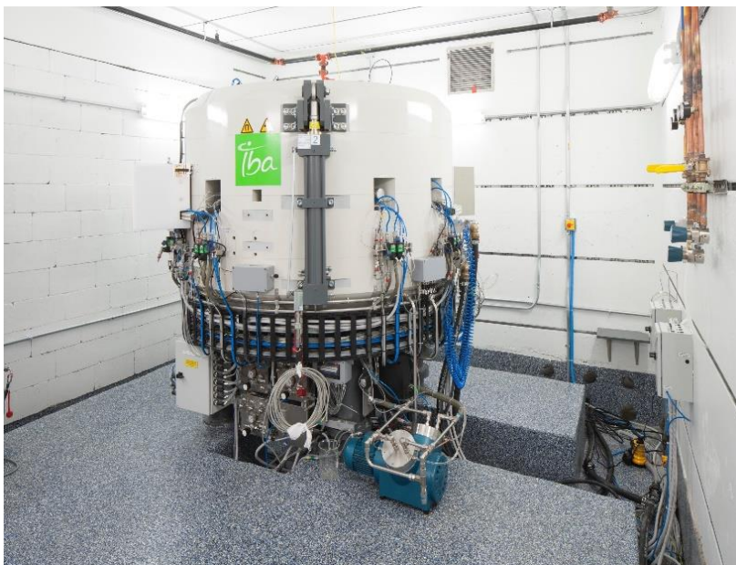
Εικόνα 2.4.8.1: Κύκλωτρο IBA Cyclone® 18 για την παραγωγή ^{18}\text{F}^- , ^{18}\text{F}_2 , ^{11}\text{C} , ^{13}\text{N} , ^{15}\text{O} (University of Chicago, 2018).
