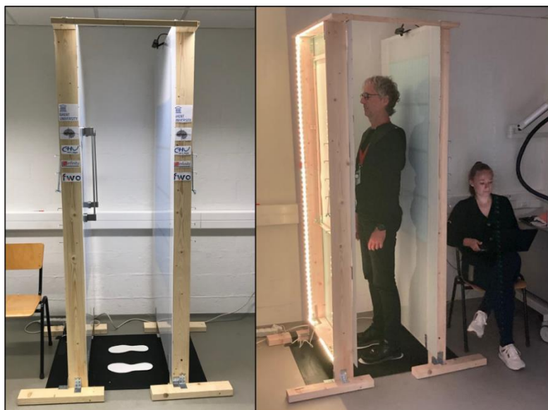
Εικόνα 6.1: Δοκιμαστική κατασκευή με τις διαστάσεις του WT–TB–PET (Muller et al., 2022).
