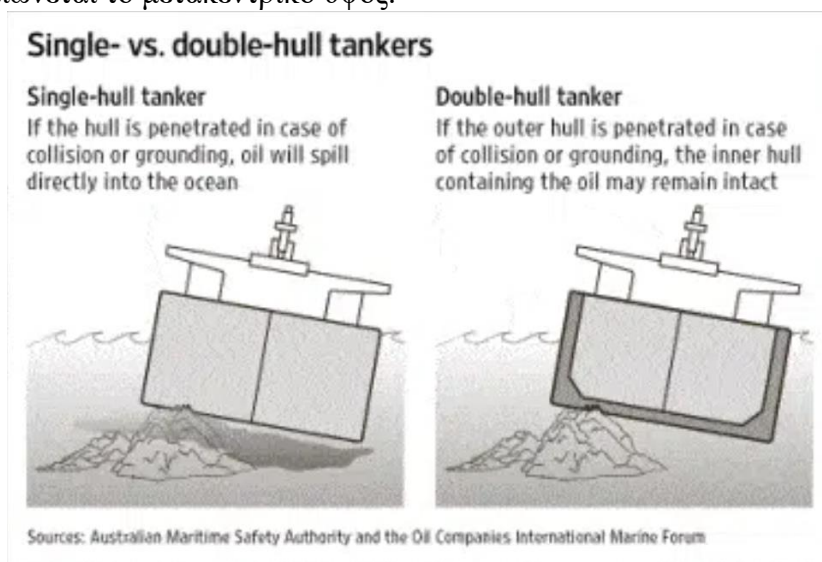
Εικόνα 2.2.5: Μονού τοιχώματος vs διπλού τοιχώματος δεξαμενόπλοια. (Πηγή: Σύνδεσμος Εικόνας )
