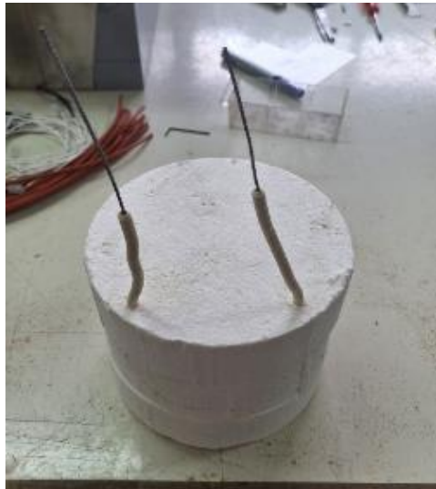
Εικόνα 2-3 Η πυρίμαχη επένδυση εξωτερικά
