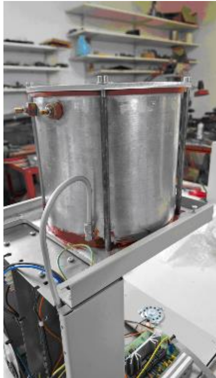
Εικόνα 2-16 Το σωληνάκι εξαγωγής του αέρα από τον θάλαμο
