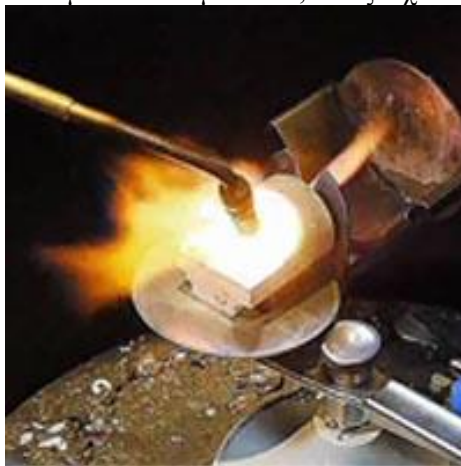
Εικόνα 1.5-2 Τεχνική χύτευσης με θέρμανση μέσω φλόγας
