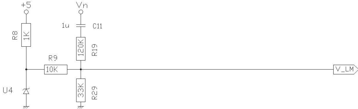
Εικόνα 2.6-3 Δημιουργία θερμοκρασίας αναφοράς θερμοζεύγους με μέτρηση της θερμοκρασίας ψυχρής επαφής με χρήση LM335
