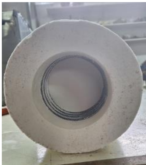
Εικόνα 2-4 Η πυρίμαχη επένδυση εσωτερικά
