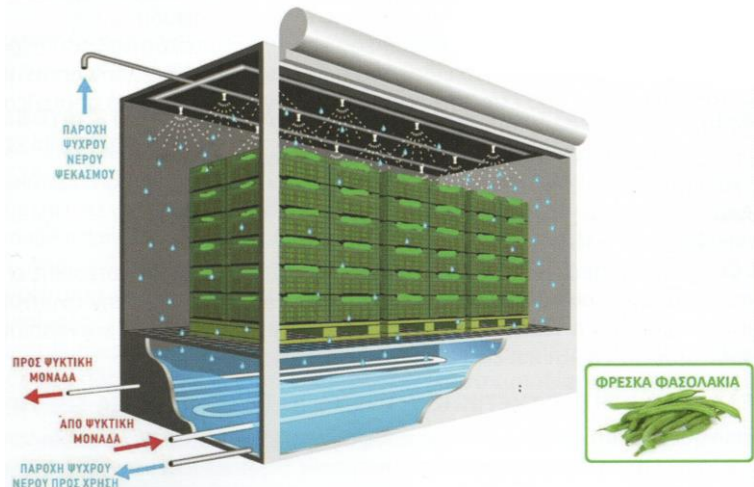
Εικόνα 17: Στατικός τύπος υδροψυξης
