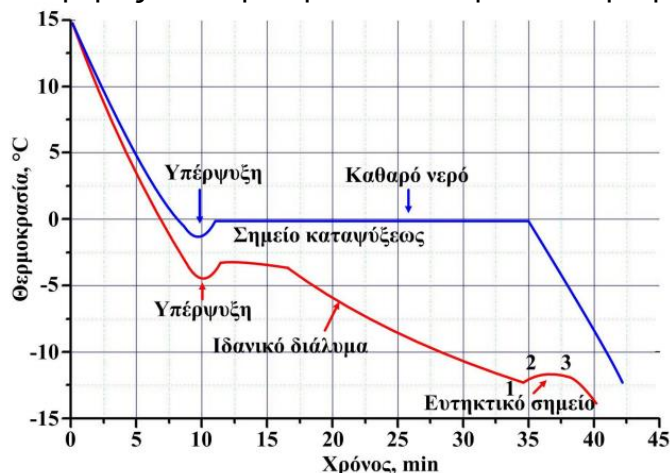
Εικόνα 21: Καμπύλες καταψύξεως νερού και καθαρού υγρού
