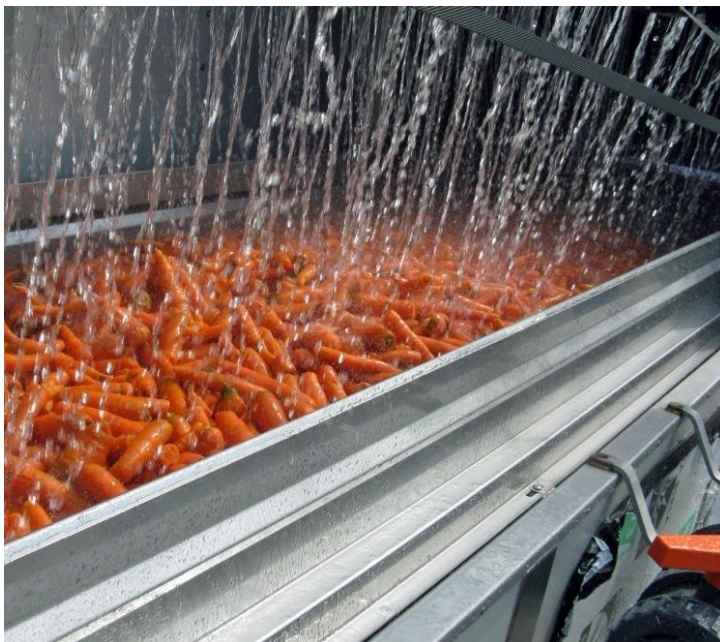
Εικόνα 16: Υδροψυξη σε μεταφορική ταινία
