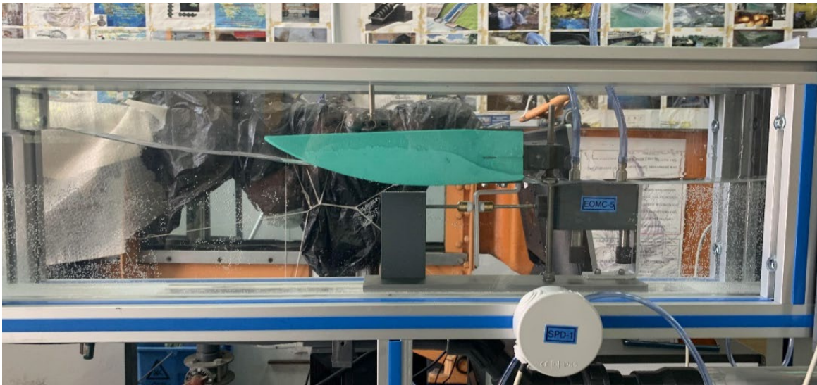
Σχήμα 5.2: Ομοίωμα μεθόδου Salter's Duck.
