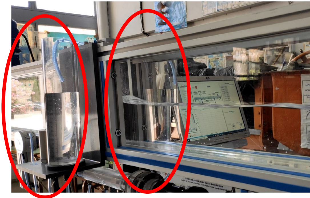
Σχήμα 5.5: Τα δύο κυλινδρικά δοχεία συλλογής νερού διαμέτρου D=68 mm.
