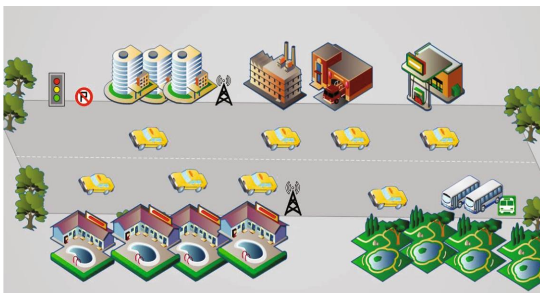
Εικόνα 9 - Τύποι επικοινωνιών σε δίκτυα ad hoc οχημάτων (VANETs).
