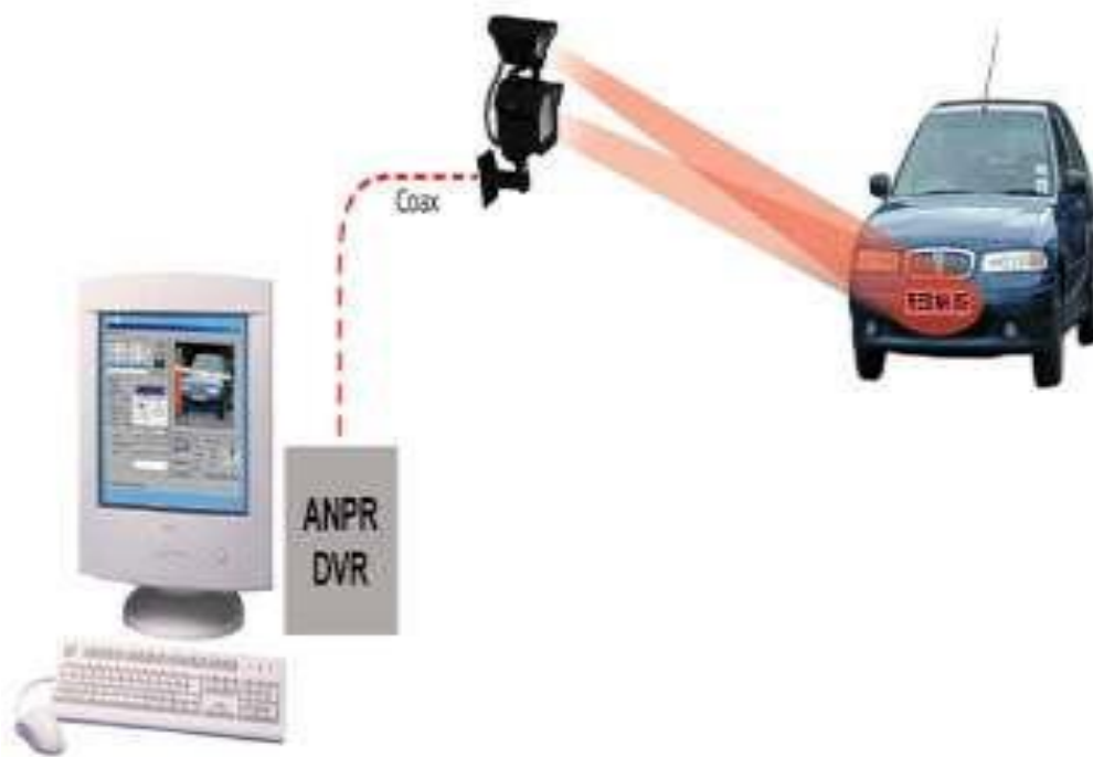
Εικόνα 12– Σύστημα Ανάγνωσης Πινακίδων Κυκλοφορίας για Έξυπνα Αυτοκίνητα της Αστυνομίας
