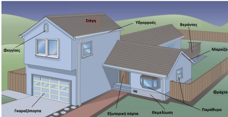
Εικόνα 13. Εν δυνάμει τρωτά στοιχεία του περιβλήματος του κτιρίου (Πηγή: Σαπουντζάκη, Δανδουλάκη, 2015)
