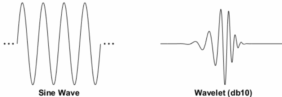
Εικόνα 18: Σύγκριση ημιτονοειδούς κύματος και κυματιδίου wavelet [12]
