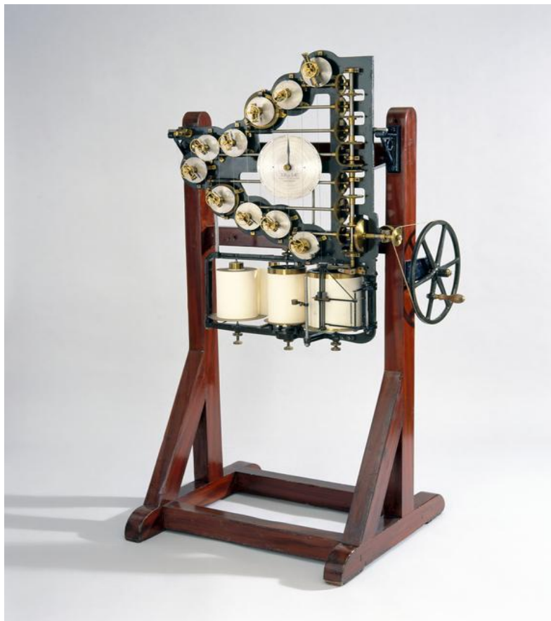
Εικόνα 2. Η μηχανή πρόβλεψης της παλίρροιας του William Thomson, 1872[II]
