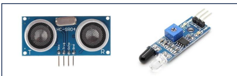
Εικόνα 6. Από αριστερά προς τα δεξιά: Αισθητήρας υπερήχων HC-SR04 και αισθητήρας υπέρυθρων[VI]
