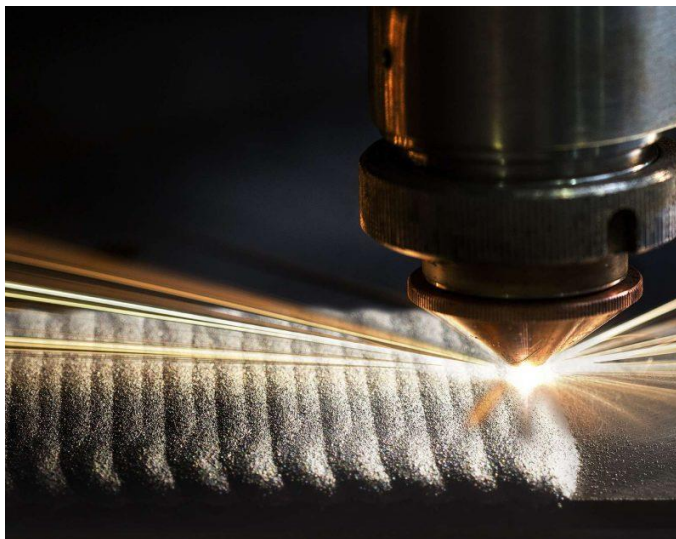
Εικόνα 12: «Δημιουργία επιστρωμάτων σε μεταλλική επιφάνεια» Πηγή: https://proleantech.com/laser-cladding-process-a-comprehensive-overview/#Applications_of_Laser_Cladding
