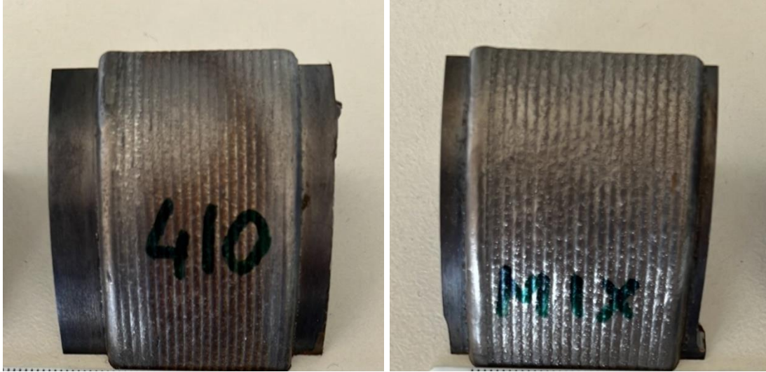
Εικόνα 32: (α) «Επεξεργασμένο δοκίμιο με επένδυση σκόνης AISI 410L», (β) «Επεξεργασμένο δοκίμιο με επένδυση μίξης σκονών AISI 410L και AISI 4140»
