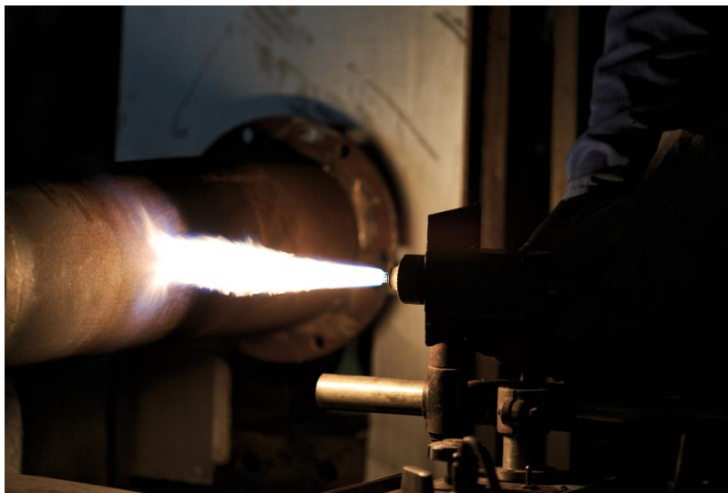
Εικόνα 2: «Ο θερμικός ψεκασμός» Πηγή: https://www.azom.com/article.aspx
