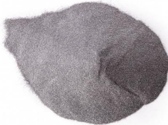
Εικόνα 25: «Η σκόνη AISI 4140»
