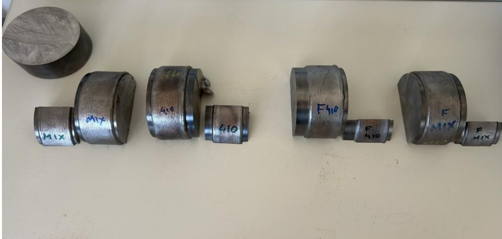
Εικόνα 34: « Τα θερμικά κατεργασμένα δοκίμια και τα μη θερμικά κατεργασμένα δοκίμια έπειτα από την επεξεργασία τους στο εργαστήριο»
