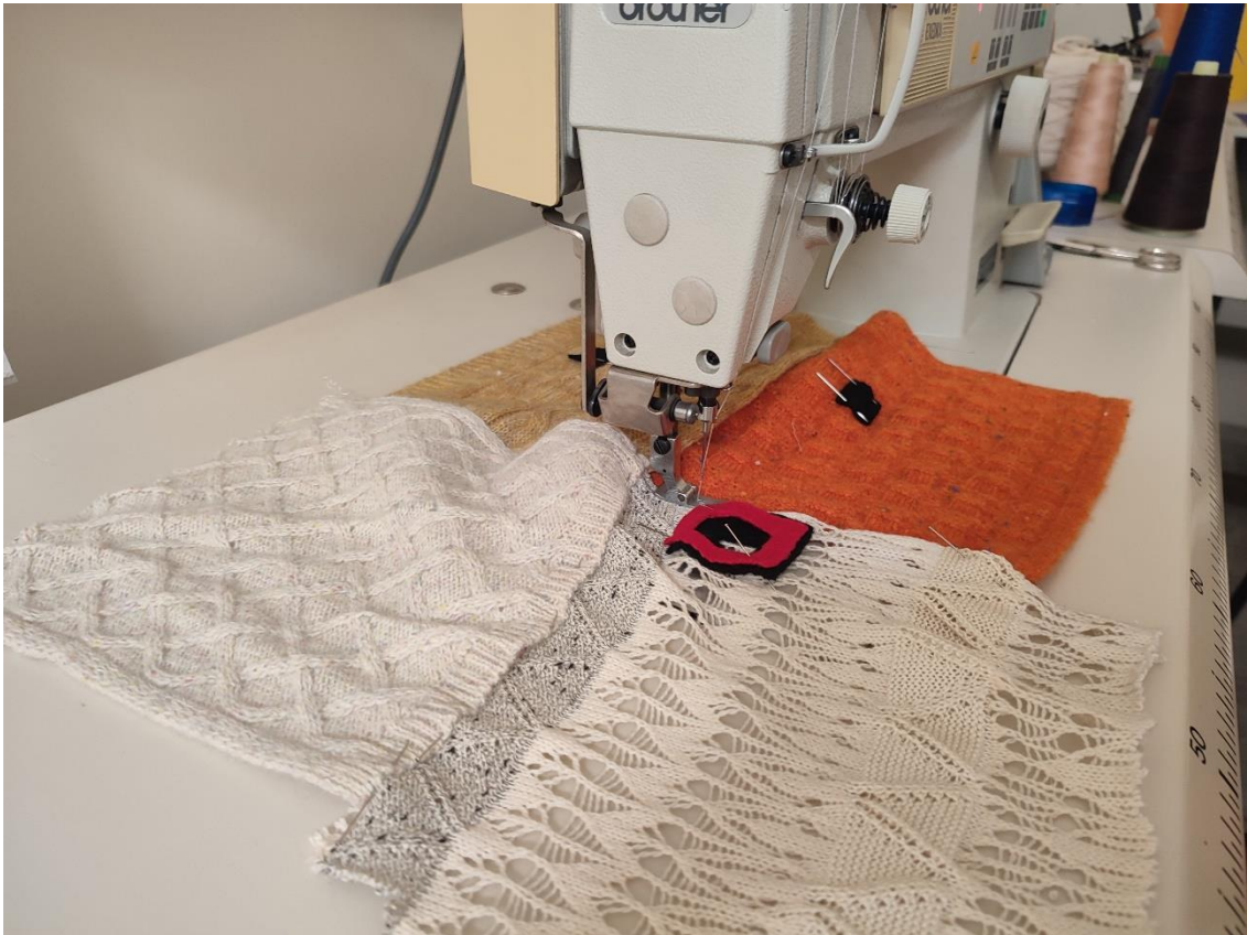
Εικόνα 54: Ένωση των υφασμάτων με τη γαζωτική μηχανή Brother.
