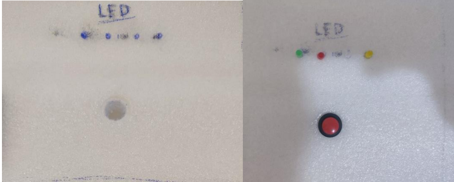
Εικόνα 44: Τοποθέτηση των LEDs και του button.
