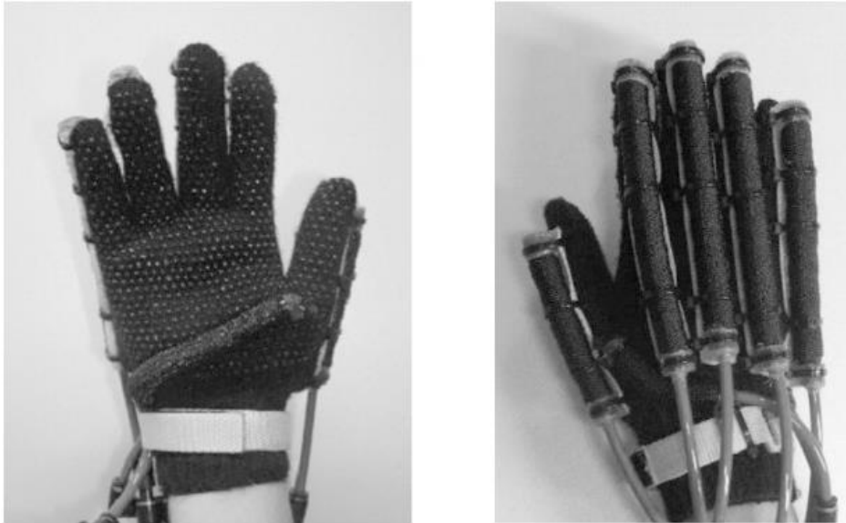
Εικόνα 16: Γάντι από τεχνητούς μύες πεπιεσμένου αέρα, [36].
