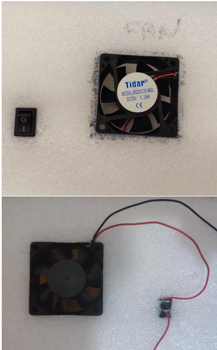
Εικόνα 45: Τοποθέτηση του ανεμιστήρα και του διακόπτη.
