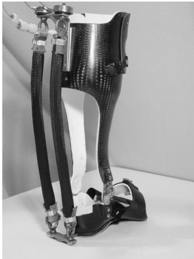
Εικόνα 15: Όρθωση αστραγάλου και ποδιού από τεχνητούς μύες πεπιεσμένου αέρα, [36].
