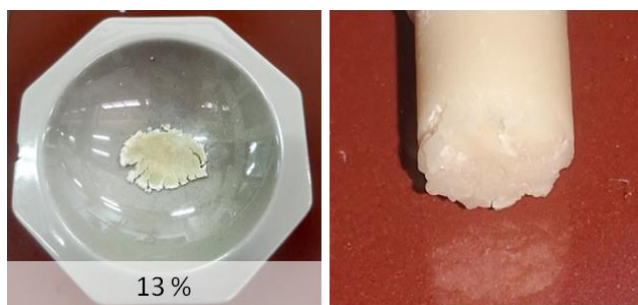
Εικόνα 6-3: Ρητίνη-13X ποσοστού 13% wt πριν (αριστερά) και μετά τον πολυμερισμό (δεξιά).
