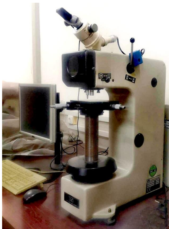
Εικόνα 6-7: Μικροσκληρόμετρο Vickers του εργαστηρίου Τεχνολογίας των Κατεργασιών της Σχολής Μηχανολόγων Μηχανικών Ε.Μ.Π..
