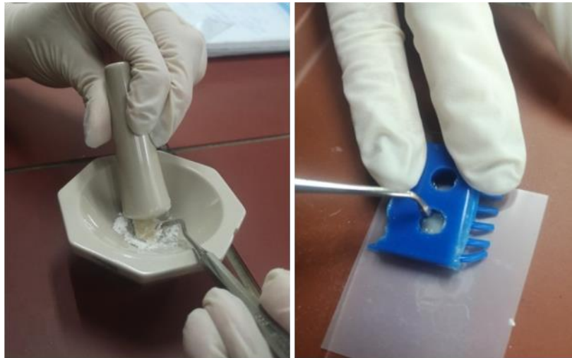
Εικόνα 6-4: Ανάμειξη του υλικού σε πορσελάνινη κάψα (αριστερά) και τοποθέτησή του στο καλούπι σιλκόνης με ειδικό οδοντιατρικό εργαλείο (δεξιά).
