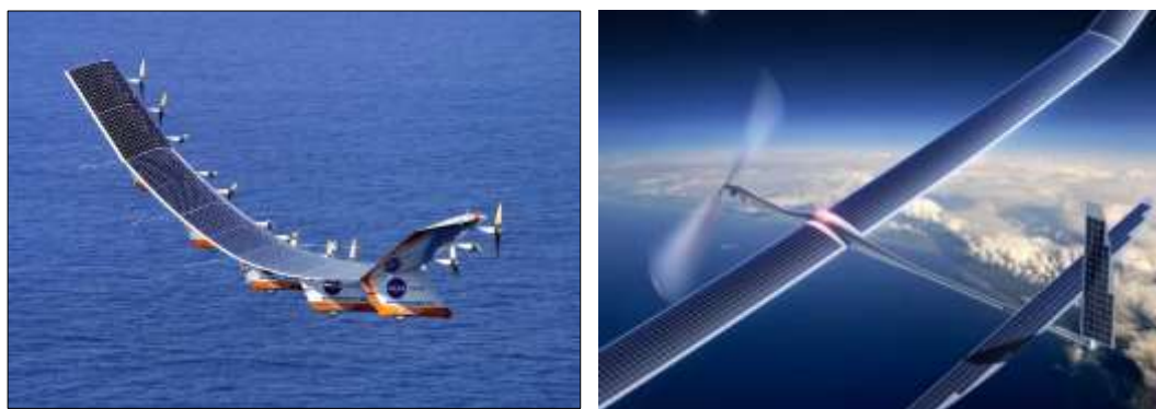
Εικόνα 1.18: Hawk 30-Solara 50, UAVs τροφοδοτούμενα με ηλιακή ενέργεια [48],[49]
