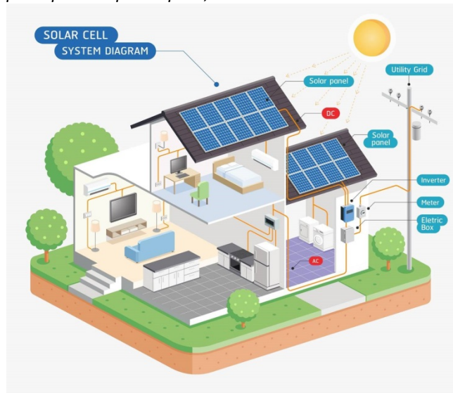
Εικόνα 2.4: Χρήση φωτοβολταϊκών στην κατοικία https://house2home.ie/solar-panels/
