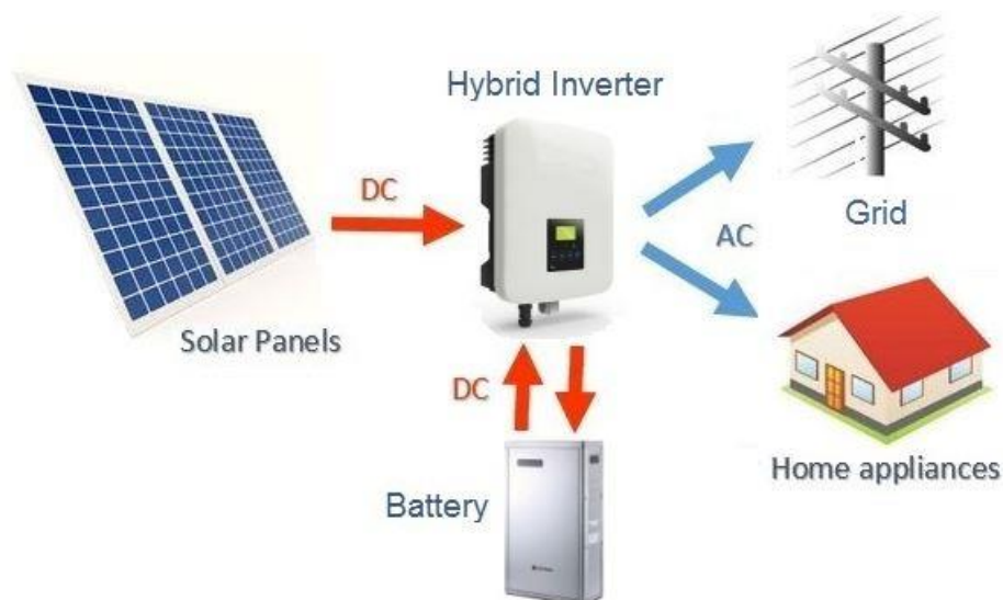
Εικόνα 5.7. Βασικό διάγραμμα διάταξης της κοινού ηλιακού υβριδικού συστήματος (συσσωρευμένη μπαταρία DC) (Passive House Institute, 2020).
