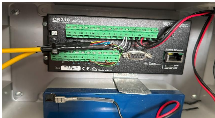
Εικόνα 13: Συνδεσμολογία Πυρανομέτρων-Μπαταρίας-Τροφοδοσίας με το καταγραφικό
