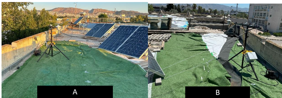
Εικόνα 23 (Α) Η κανονική διάταξη του χλοοτάπητα PP. (Β) Η διάταξη με την μετακίνηση του ρολού από ριπή ανέμου.
