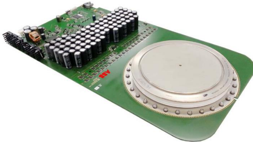
Εικόνα3. PRESS PACK IGCT + GATE DRIVER CIRCUIT (ABB POWER SEMICONDUCTORS)
