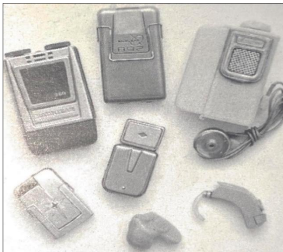
Εικόνα 1α. Ακουστικά βαρηκοΐας κρυσταλλολυχνίας. Επάνω και αριστερά διακρίνονται τα ακουστικά που φοριούνταν στο σώμα και κάτω δεξιά ένα οπισθοωτιαίο και ένα ενδοωτιαίο ακουστικό (Πηγή: James W. Hall, III, 2015, Ιδιοκτησία Wayne Staab)
