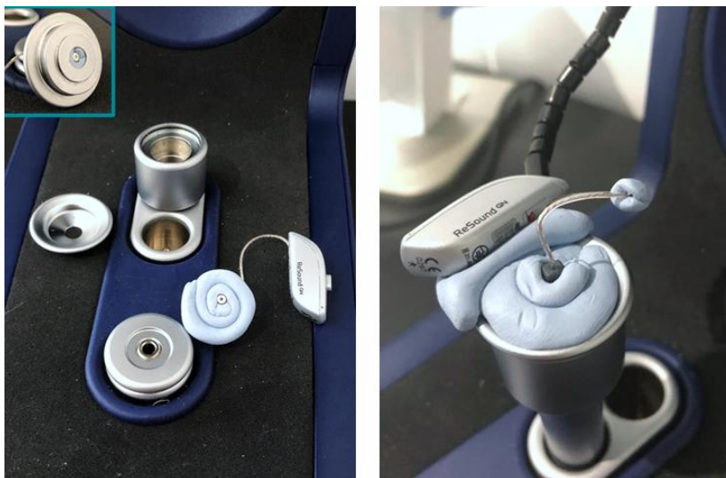
Εικόνα 8β. Τοποθέτηση ακουστικού τύπου RIC στο testbox ώστε να πραγματοποιηθεί η μέτρηση της λειτουργικότητας του μεγαφώνου και του μικροφώνου του. Το μεγάφωνο του ακουστικού μονώνεται μέσω ειδικής πλαστελίνης και κατόπιν ο χειριστής το τοποθετεί ώστε
