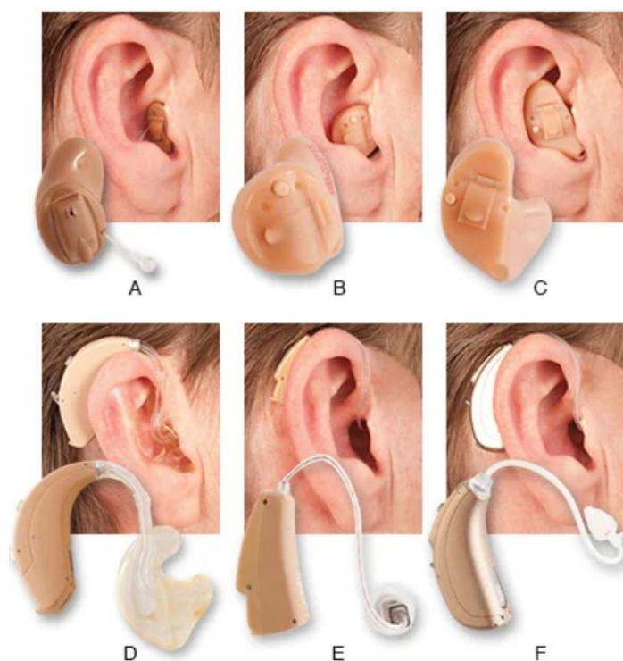
Εικόνα 3β. Διάφοροι τύποι ακουστικών και η εφαρμογή τους. A: CIC, B: ITC, C: ITE, D: BTE, E: RIC, F: Open Dome (ανοιχτού τύπου, με σκέτη θηλή χωρίς μεγάφωνο), (Πηγή: Mayo Foundation For Medical Education and Research)
