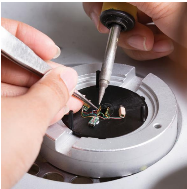
Εικόνα 7δ. Κόλληση των καλωδίων του ολοκληρωμένου κυκλώματος επάνω στις επαφές της μπαταρίας (Πηγή: Phonak Custom Products , 2016, 041-1380-03-Custom-Process-Brochure.pdf (phonak.com) )
