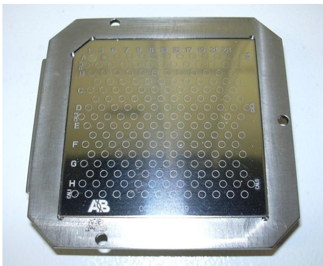
Εικόνα 15 – Μεταλλική πλάκα δείγματος πηγής MALDI
