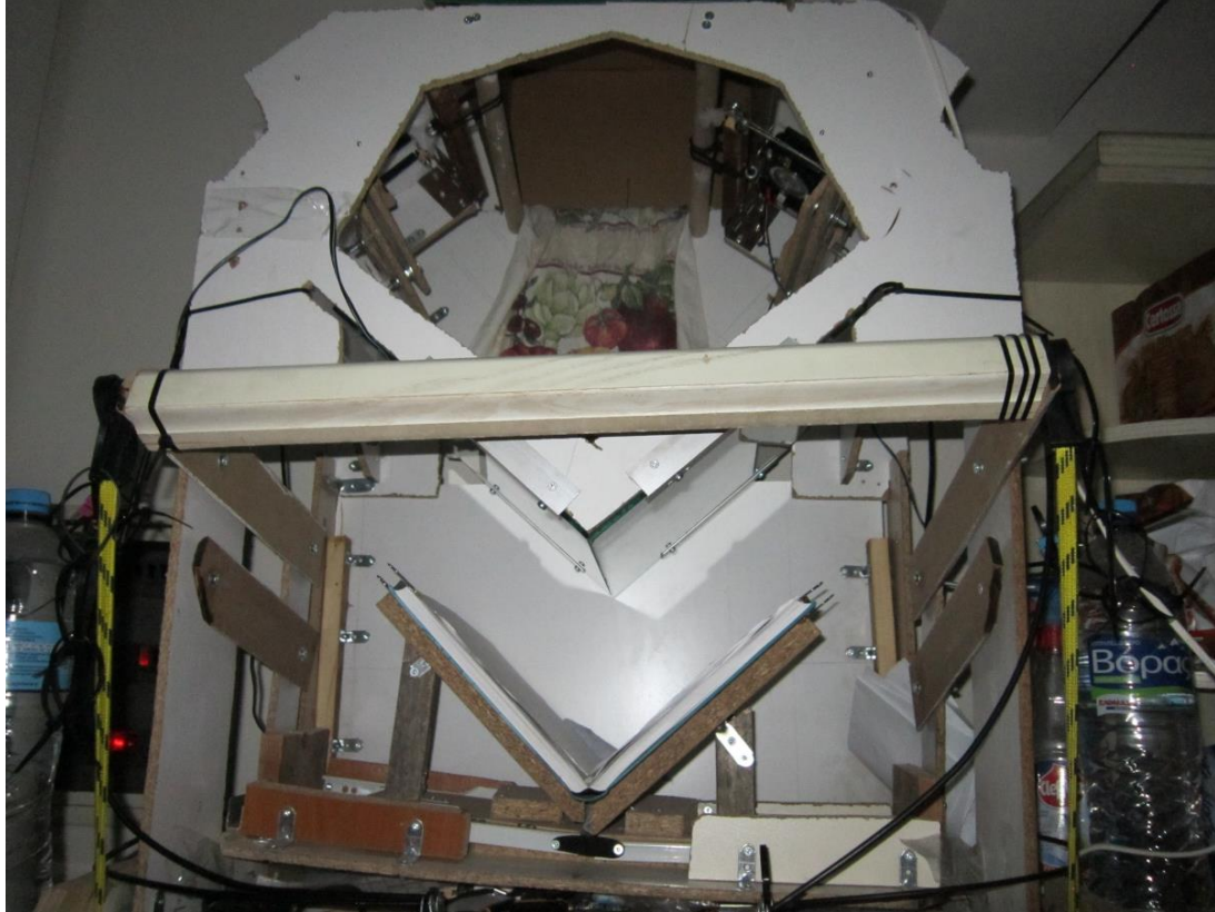
Εικόνα 19 Vshape diybookscanner με καλώδια ποδηλάτου
