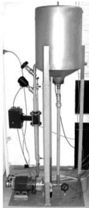
Εικόνα 43 Φωτογραφία της διερευνηθείσας μονάδας φυγοκεντρικής αντλίας-σωλήνων-δεξαμενής
