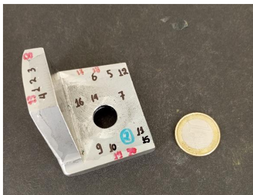
Εικόνα 9.41 Μακροσκληρομέτρηση του εξαρτήματος 2
