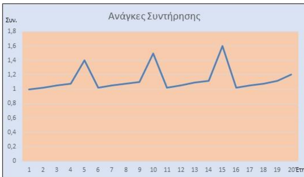
Σχήμα 6.4 Ανάγκες Συντήρησης του ηλεκτρομηχανολογικού εξοπλισμού.
