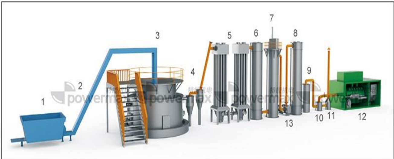
Εικόνα 6.7 Διάγραμμα διεργασίας μονάδας βιομάζας με αεριοποιητή σταθερής κλίνης καθοδικού ρεύματος (dawn draft)
