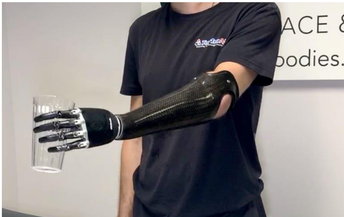
Εικόνα 3.3 Παράδειγμα μωηλεκτρικής πρόθεσης
