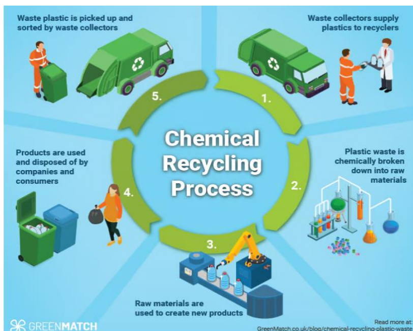
Εικόνα 7: Χημική Ανακύκλωση πλαστικών απορριμμάτων ( https://www.greenmatch.co.uk )
