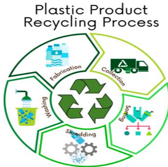
Εικόνα 6: Μηχανική διαδικασία ανακύκλωσης απορριμμάτων πλαστικών [21]
