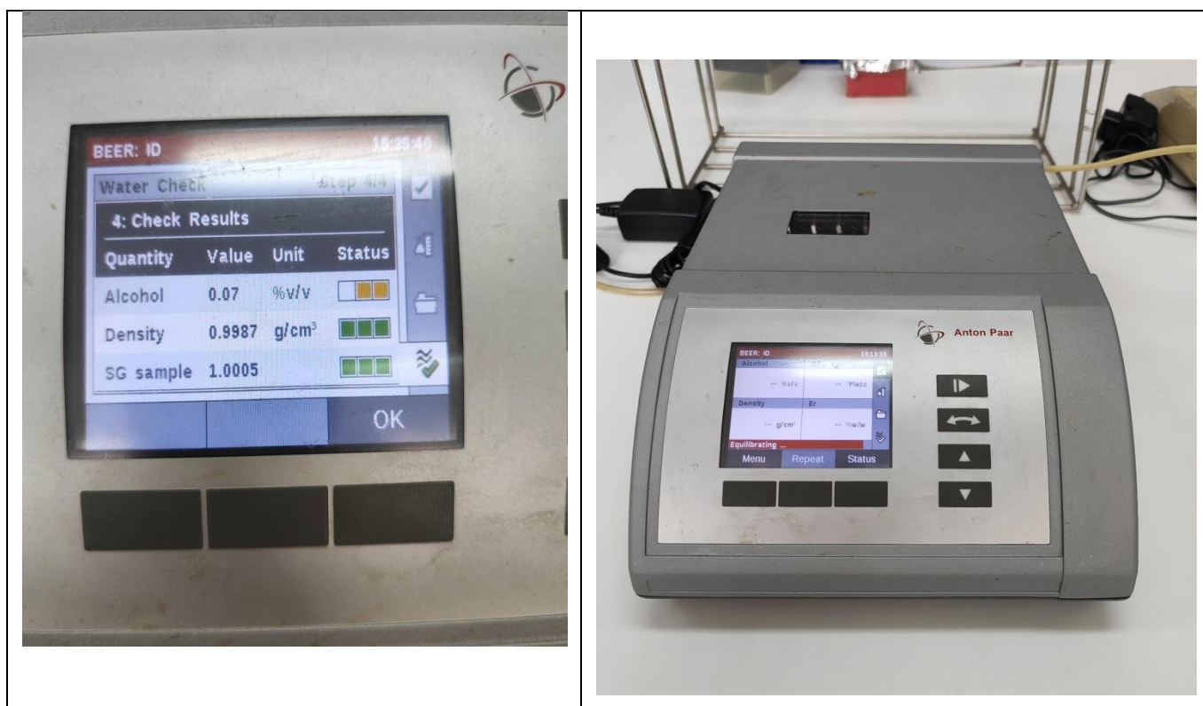
Εικόνα 5 Προσδιορισμός περιεκτικότητας σε αιθανόλη (% v/v) , πυκνότητας (g/cm 3 ) , και ειδικής βαρύτητας (SG)
