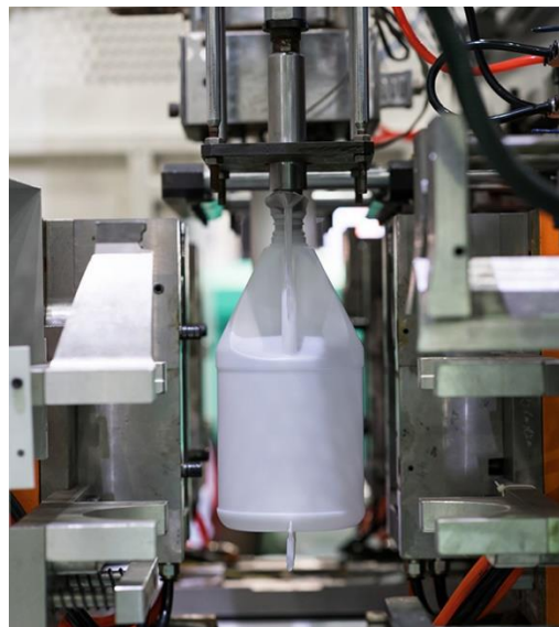
Σχήμα 2.19: Προϊόν παραγόμενο με εμφύσηση. Στην φωτογραφία είναι εμφανές το σκράπ στο άνω και κάτω μέρος του μπουκαλιού [44]
