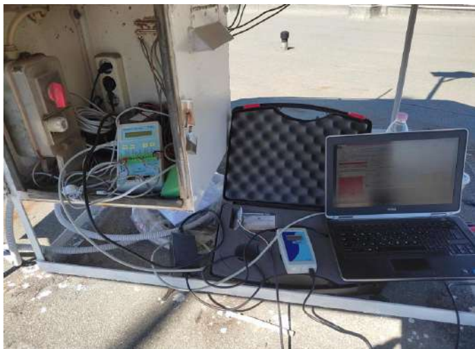
ΕΙΚΟΝΑ 15: ΔΙΑΔΙΚΑΣΙΑ ΣΥΝΔΕΣΗΣ ΤΟΥ ΠΡΟΤΥΠΟΥ ΠΥΡΑΝΟΜΕΤΡΟΥ
