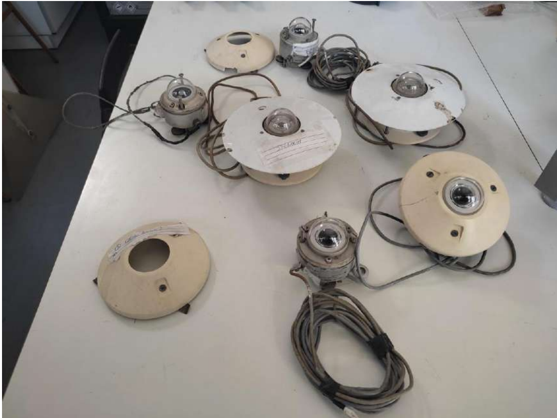
ΕΙΚΟΝΑ 7: ΠΥΡΑΝΟΜΕΤΡΑ ΠΡΙΝ ΤΗΝ ΤΟΠΟΘΕΤΗΣΗ ΣΤΗΝ ΕΓΚΑΤΑΣΤΑΣΗ
