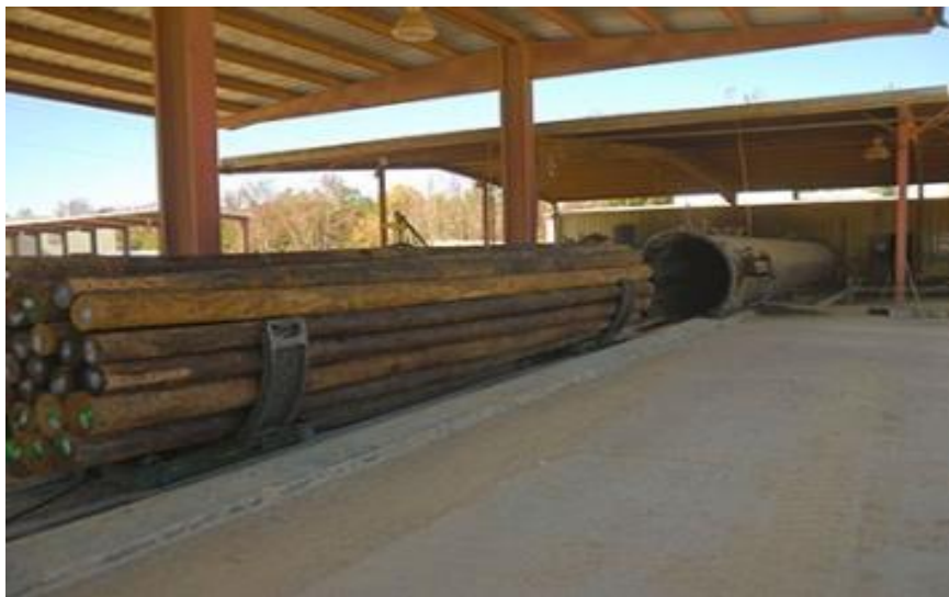
Εικόνα 10 Θάλαμο - Δεξαμενή εμποτισμού (κλειστοί κύλινδροι)
