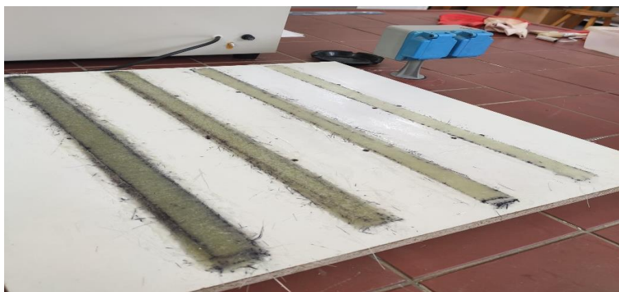
Εικόνα 6. Κατασκευή δοκιμίων με 1 έως 8 στρώσεις με τη μέθοδο Hand-lay up .
