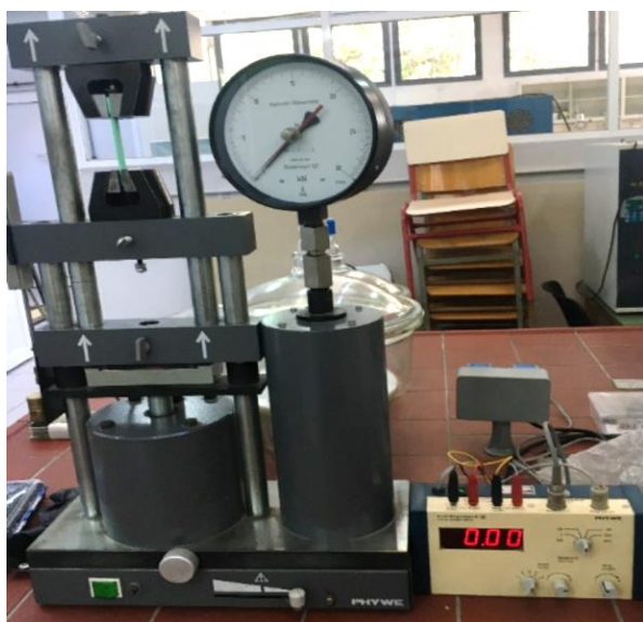
Εικόνα 9. Διάταξη PHYWE για τη δοκιμασία μονοαξονικού εφελκυσμού.
