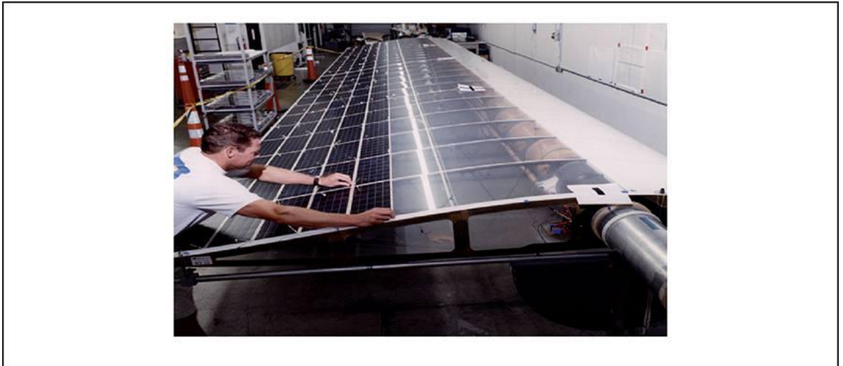
Εικόνα 48 Τοποθέτηση ηλιακών κυψελών στην πτέρυγα του Helios
