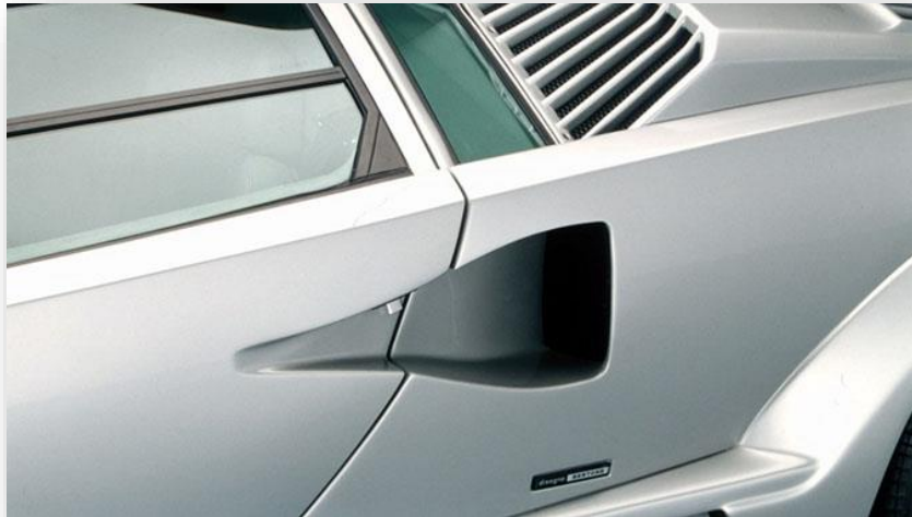
Εικόνα 27: NACA Duct αεραγωγός στο πλαινό τμήμα της Lamborghini
