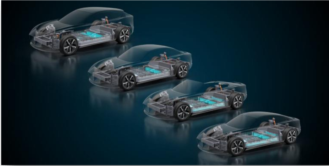
Εικόνα 71: Δυνατότητα ποικίλων μορφών αμαξωμάτων στην ίδια πλατφόρμα δίνεται από την ηλεκτροκίνηση
