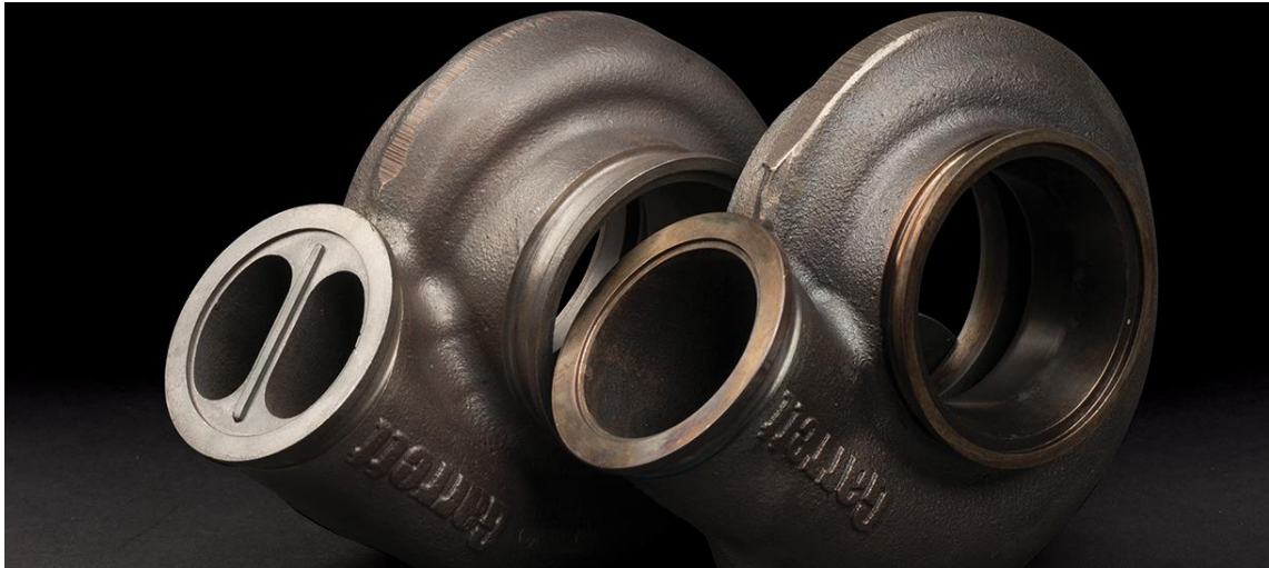
Εικόνα 31: Twin scroll turbine αριστερά και Single scroll turbine δεξιά [Πηγή: DSPORTMAG]
