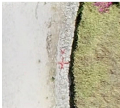
Εικόνα 15 – Φωτοσταθερό Πηγή: Εικόνα από τις εργασίες πεδίου
