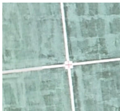
Εικόνα 17 – Φωτοσταθερό Πηγή: Εικόνα από τις εργασίες πεδίου
