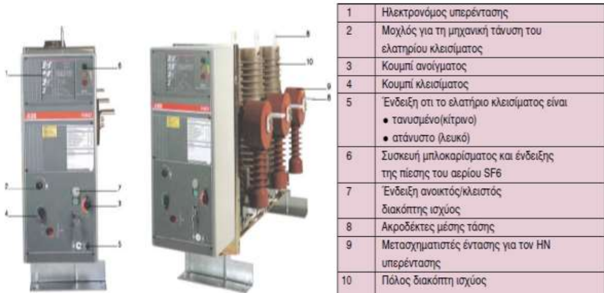
Εικόνα 1.22 : Διακόπτης Ισχύος SF6 και ανάλυση των αριθμών που βρίσκονται στην εικόνα. [15]
