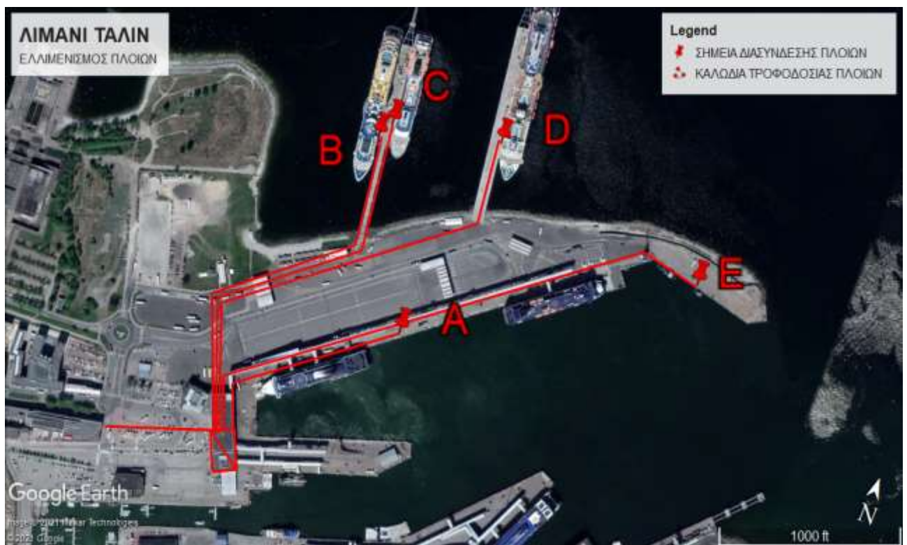
Εικόνα 6.35 : Σημεία διασύνδεσης των ελλιμενισμένων πλοίων στις αποβάθρες του Ταλίν. [44]
