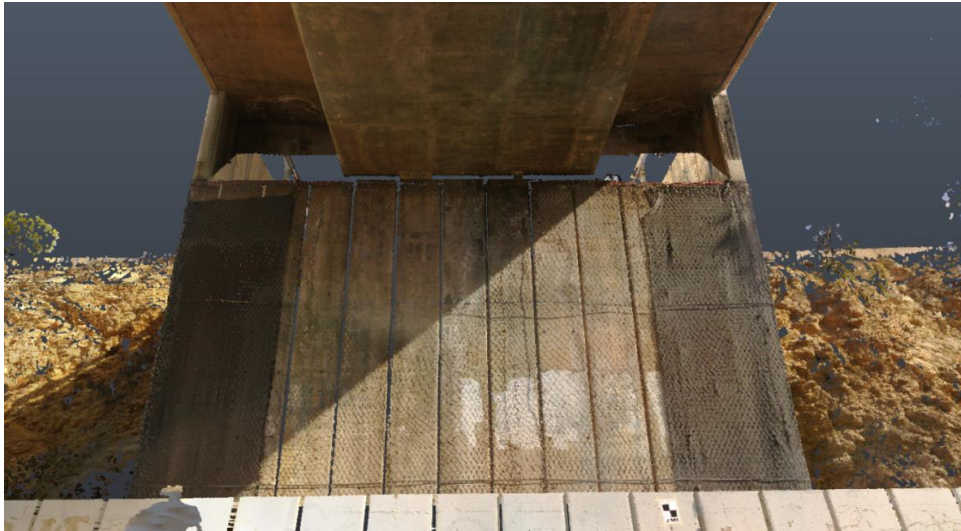
Εικόνα 4.34: Στιγμιότυπο τελικού νέφους 3d σαρωτή έπειτα από τον τελικό καθαρισμό σε περιβάλλον Autodesk Recap
