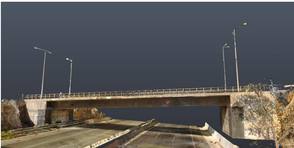
Εικόνα 4.36: Στιγμιότυπο τελικού νέφους 3d σαρωτή έπειτα από τον τελικό καθαρισμό σε περιβάλλον Autodesk Recap
