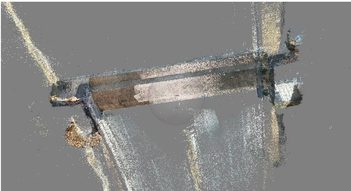
Εικόνα 4.42: Αραιό νέφος σημείων Σμηνα Mavic Air 3 (Bottom View γέφυρας)
