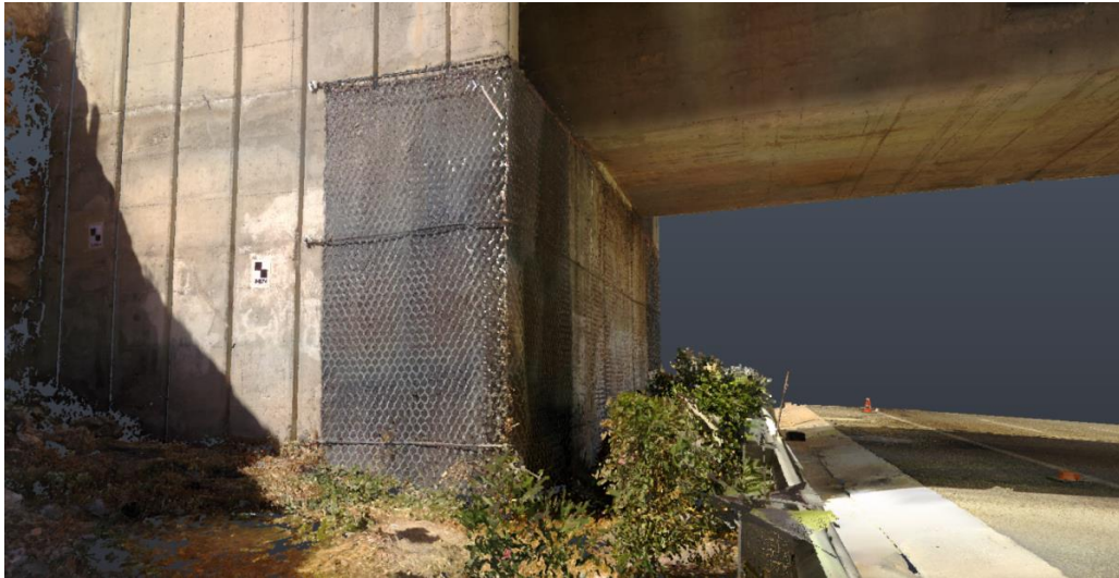
Εικόνα 4.31: Στιγμιότυπο τελικού νέφους 3d σαρωτή έπειτα από τον τελικό καθαρισμό σε περιβάλλον Autodesk Recap
