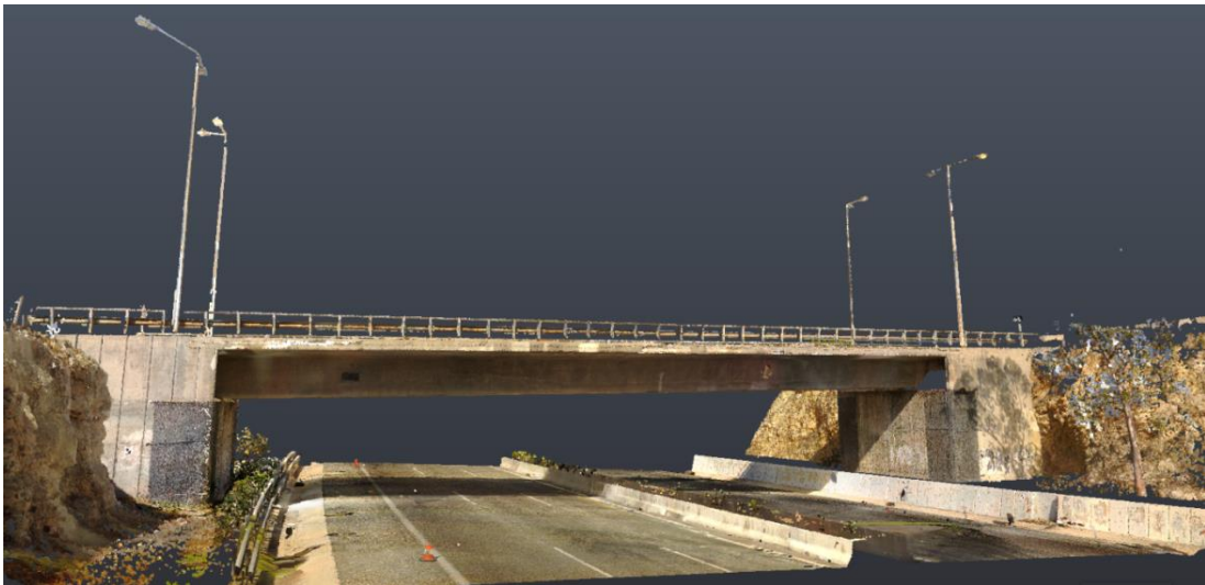
Εικόνα 4.35: Στιγμιότυπο τελικού νέφους 3d σαρωτή έπειτα από τον τελικό καθαρισμό σε περιβάλλον Autodesk Recap
