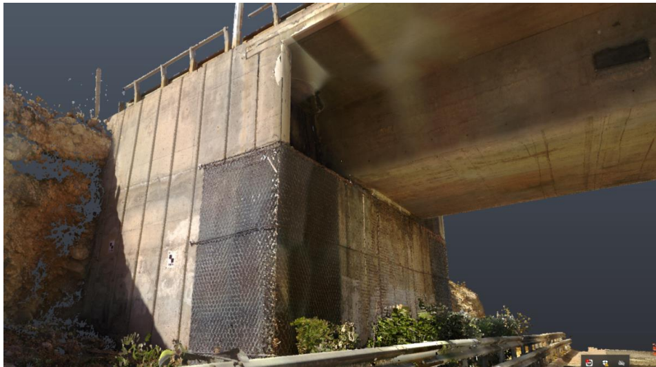
Εικόνα 4.32: Στιγμιότυπο τελικού νέφους 3d σαρωτή έπειτα από τον τελικό καθαρισμό σε περιβάλλον Autodesk Recap
