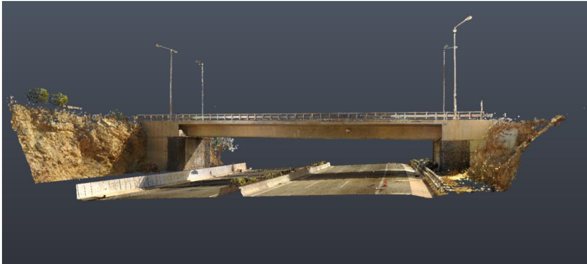
Εικόνα 4.28: Στιγμιότυπο τελικού νέφους 3d σαρωτή έπειτα από τον τελικό καθαρισμό σε περιβάλλον Autodesk Recap
