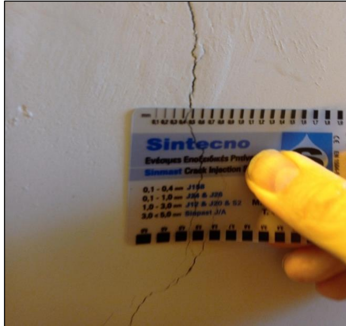
Εικόνα 2.9: Ρωγμόμετρο σε μορφή κάρτας με γνωστά πάχη
