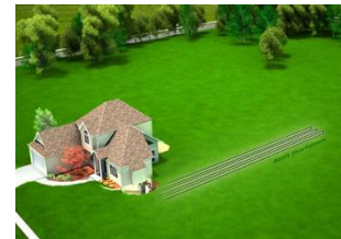
Εικόνα 25: Οριζόντιο κύκλωμα γεωθερμίας
