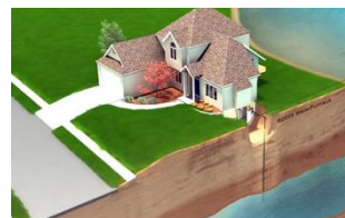
Εικόνα 28: Γεωθερμικό ανοικτό κύκλωμα
