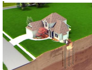
Εικόνα 26: Κατακόρυφο κύκλωμα γεωθερμίας
