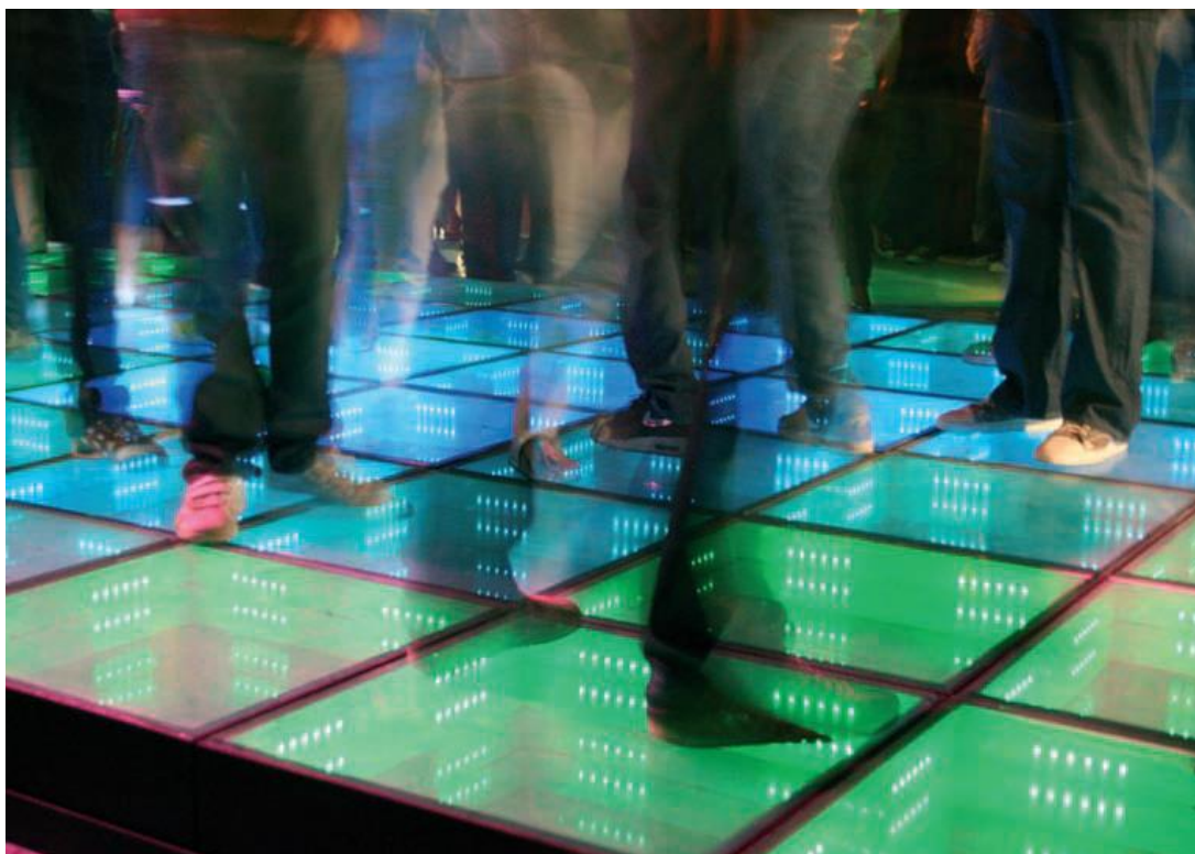
Εικόνα 29: Δάπεδο από πιεζοηλεκτρικά πλακίδια με ενσωματωμένες φωτο-διόδους. Η ενέργεια που παράγεται από την κίνηση μετατρέπεται σε ηλεκτρισμό, ( shorturl.at/zKMO7 ,σελ.79), ανακτήθηκε 2/1/2021
