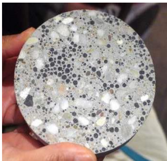
Εικόνα 32: Βίο-σκυρόδεμα, αυτό-θεραπευόμενο σκυρόδεμα
