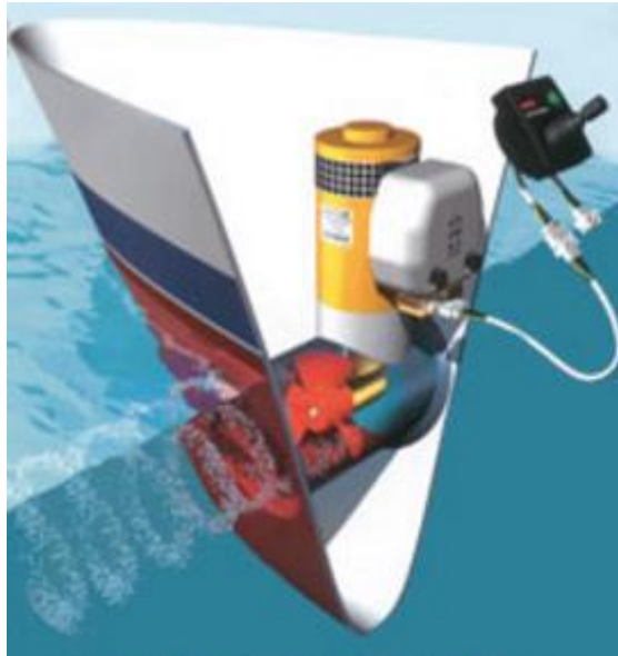
Εικόνα 34: Παράδειγμα εφαρμογής ενός bow thruster σε πλοίο.
