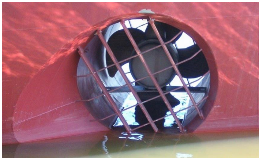
Εικόνα 35: Παράδειγμα ενός bow thruster σε πραγματικό πλοίο.
