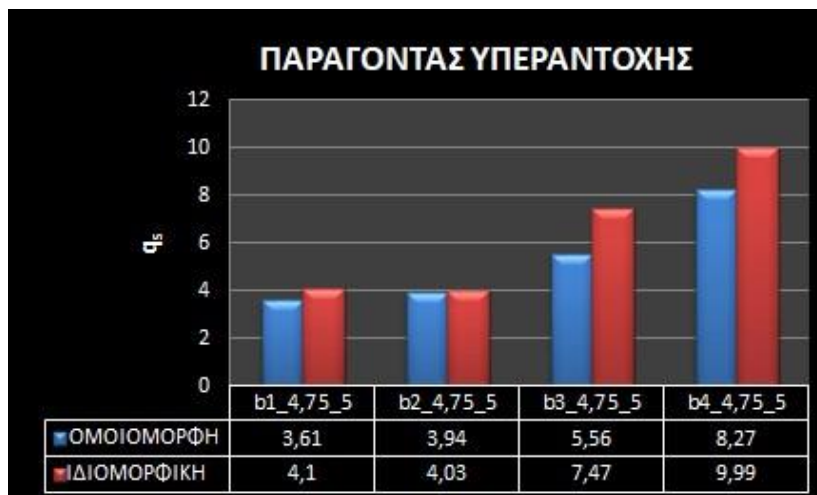
Σχήμα 7. 41: Παράγοντας υπεραντοχής πεντάωροφων κτιρίων με άνοιγμα 4,75m
