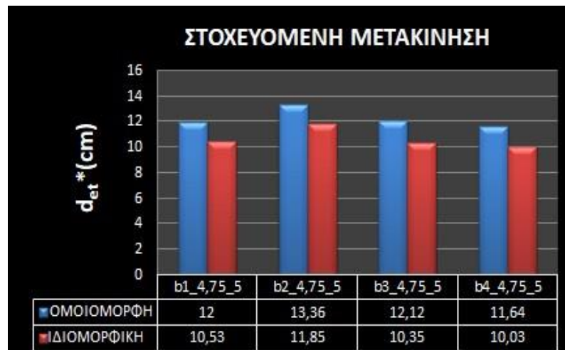
Σχήμα 7. 46: Στοχευόμενη μετακίνηση πενταώροφων κτιρίων με άνοιγμα 4,75m
