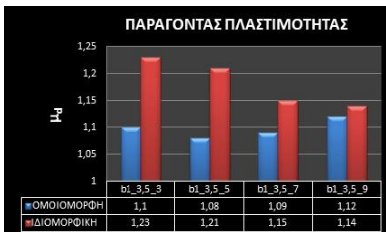
Σχήμα 7. 37: Παράγοντας πλαστιμότητας κτιρίων κατηγορίας 1 με άνοιγμα 3,5m
