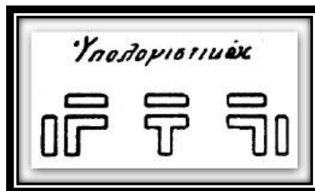
Σχήμα 2. 2: Τοιχώματα μορφής Γ, Τ
