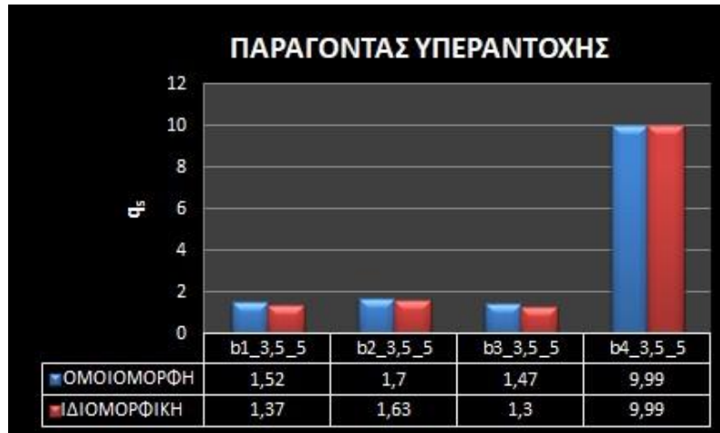
Σχήμα 7. 40: Παράγοντας υπεραντοχής πεντάωροφων κτιρίων με άνοιγμα 3,5m
