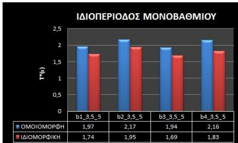
Σχήμα 7. 35: Ιδιοπερίοδος πεντάροφων κτιρίων με άνοιγμα 3,5m
