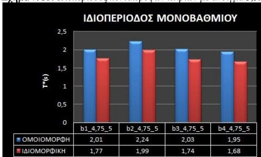
Σχήμα 7. 36: Ιδιοπερίοδος πεντάροφων κτιρίων με άνοιγμα 4,75m
